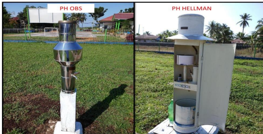
Gambar 2.5: Alat ukur hujan ombrometer dan jenis Hellman (BMKG, 2018).
