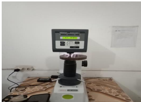
Gambar 4.5 Melakukan uji kekerasan pada spesimen
