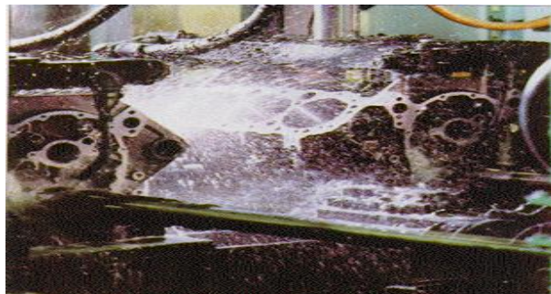
Gambar 2.1. Pemberian cairan pendingin dengan cara dibanjiri cairan pendingin pada benda kerja
