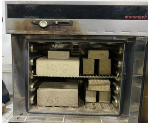
Gambar 4.1: Proses pengeringan benda uji
