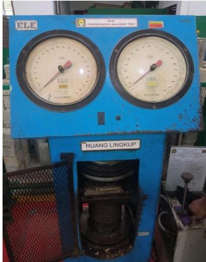
Gambar 4. 8: Proses Pengujian Kuat Tekan Bata
