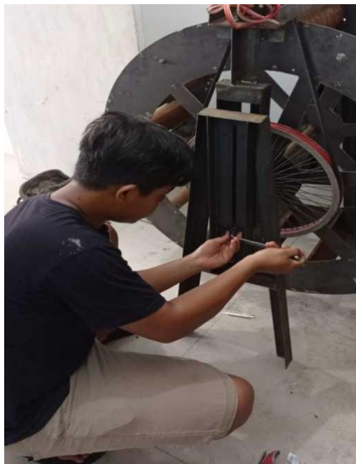
Gambar 4.6 Pemasangan Baut Pada Rangka
