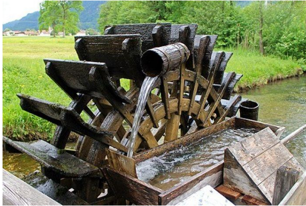
Gambar 2.5 Kincir Di Aliran Irigasi
