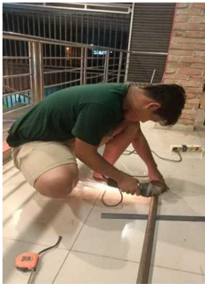
Gambar 4.1 Pematangan Besi Untuk Rangka
