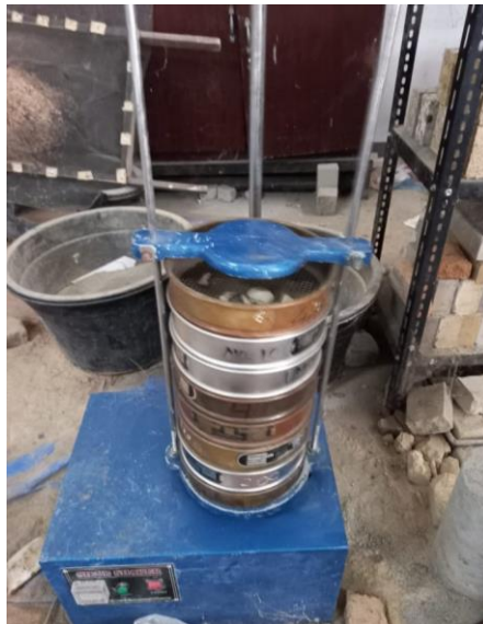
Gambar 4.5: Analisa Butiran Tanah Merah.
