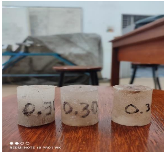
Gambar 4.8. Bentuk spesimen hasil dari pengujian tekan 0,30 gram serat duria : 50 gram resin
