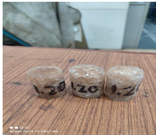
Gambar 4.11. Bentuk spesimen hadil dari pengujian tekan 1.20 gram serat duria : 50 gram resin
