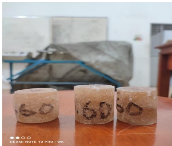
Gambar 4.9. Bentuk Spesimen hasil dari pengujian tekan 0,60 gram serat duria : 50 gram resin
