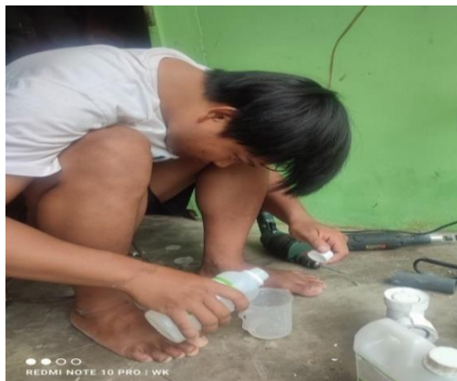
Gambar 4.3. Penuangan resin sebanyak 99,40 gram
