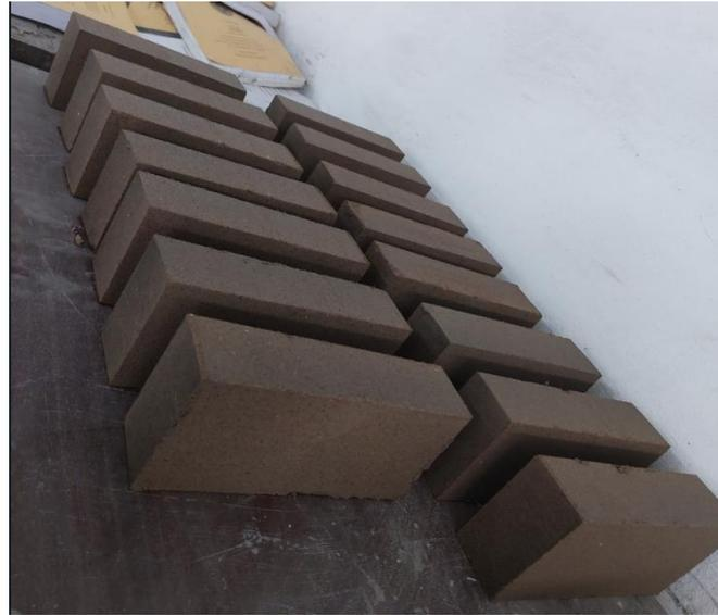
Gambar 4.10 Benda uji sifat bata tanah merah
