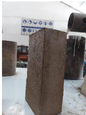
Gambar 4.7 kondisi bata setelah di uji kadar garam
