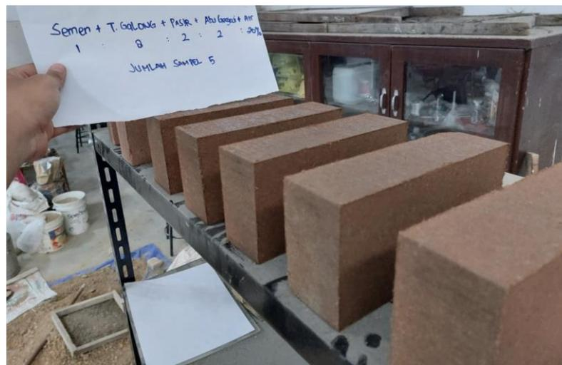
Gambar 4.9 Benda uji sifat tampak tanah galang
