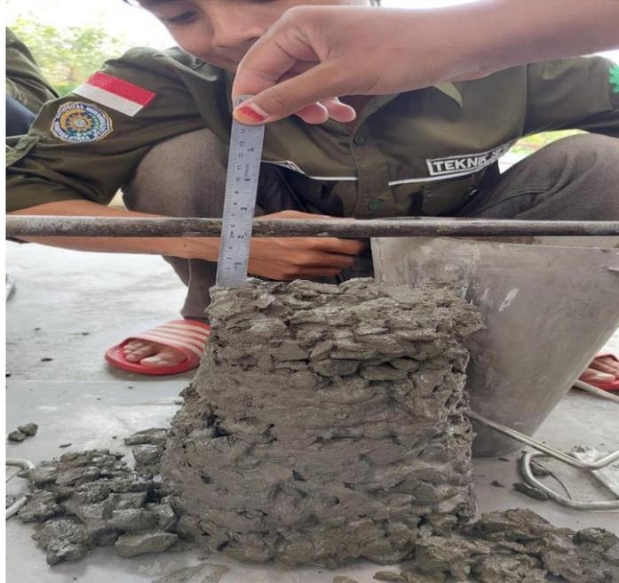
Gambar L.12 : *Slump Test*
