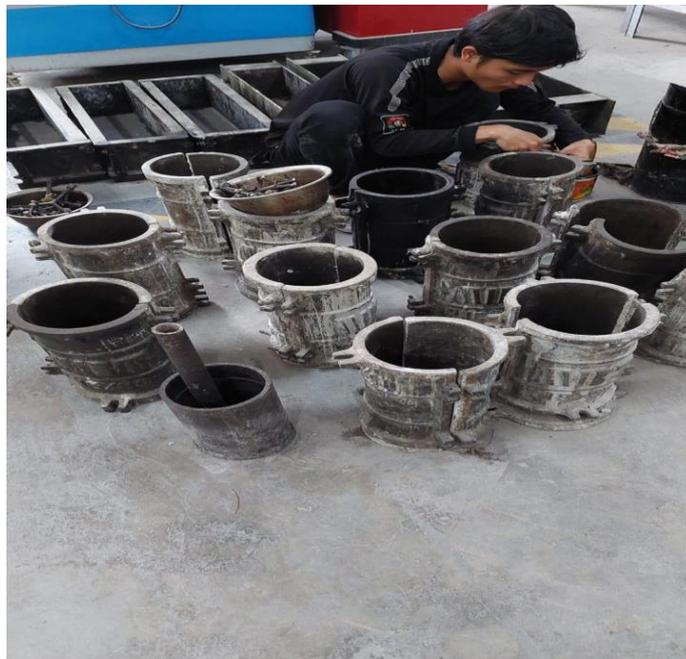
Gambar L.13 : Cetakan Benda Uji
