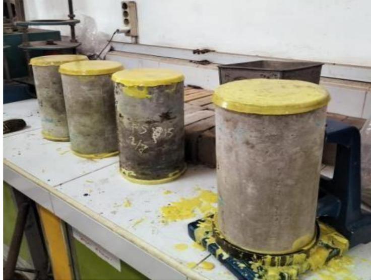
Gambar L.14 : Pemasangan *capping* pada benda uji
