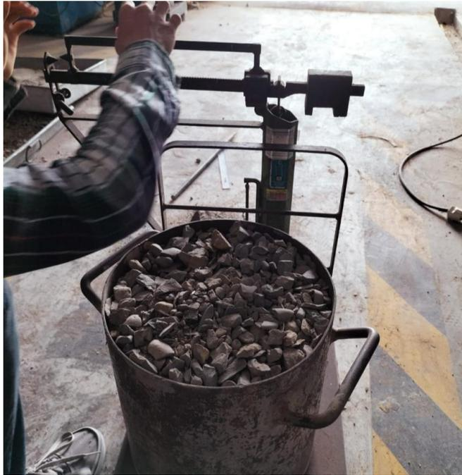
Gambar L.4 : Pengujian Berat Isi Agregat
