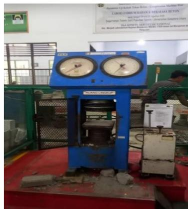
Gambar 3.26 : Mesin Penguji Modulus Elastisitas
