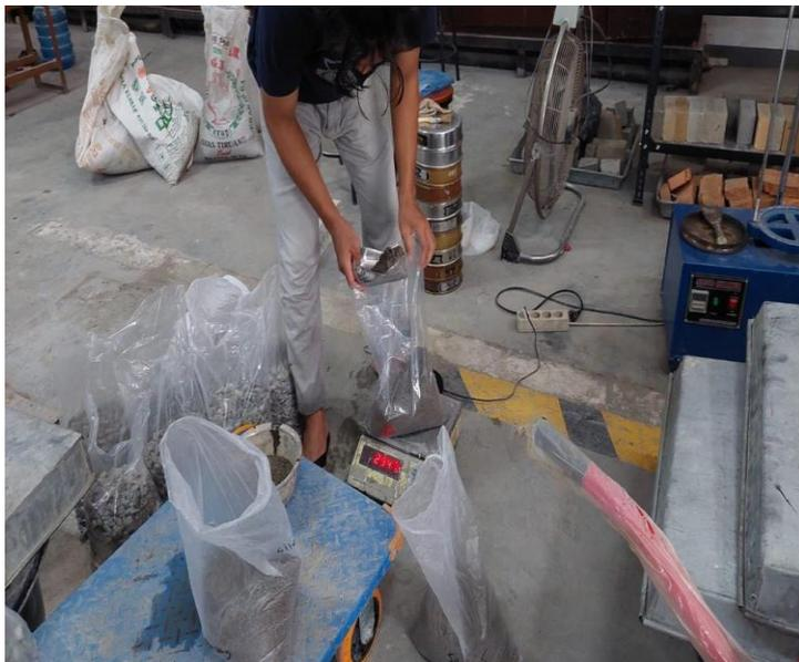
Gambar L.9 : Penimbangan Agregat
