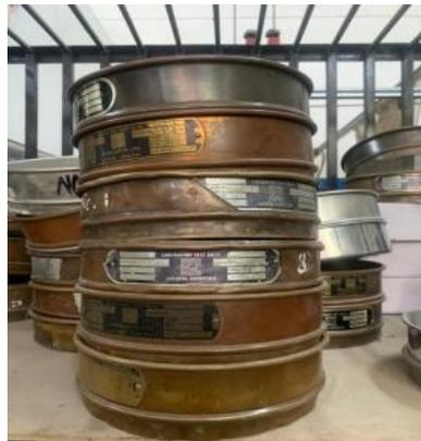
Gambar 3.8 : Saringan agregat
