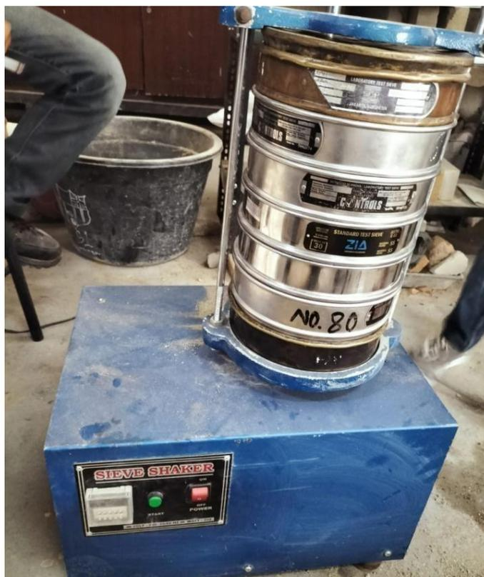
Gambar L.6 : Pengujian Analisa Saringan
