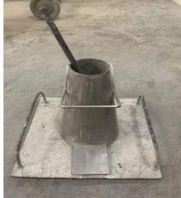
Gambar 3.22 : Satu set alat slump test
