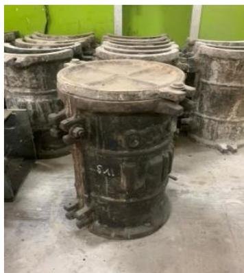
Gambar 3.21 : Cetakan benda uji silinder
