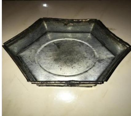
Gambar 3.3 Cetakan paving block
