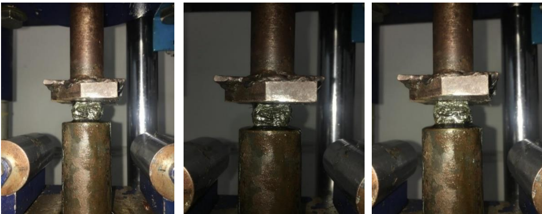
Gambar 4.2 Pengujian spesimen komposisi 70% : 30%
