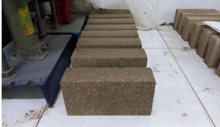
Gambar 4.30: Benda uji daya tampak bata untuk tanah merah.
