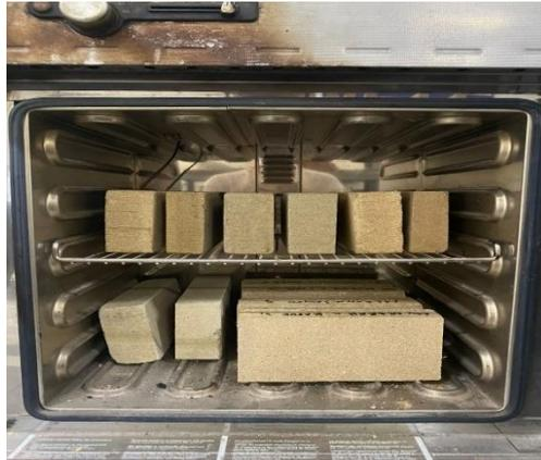
Gambar 4.19: Proses pengeringan benda uji di dalam oven.
