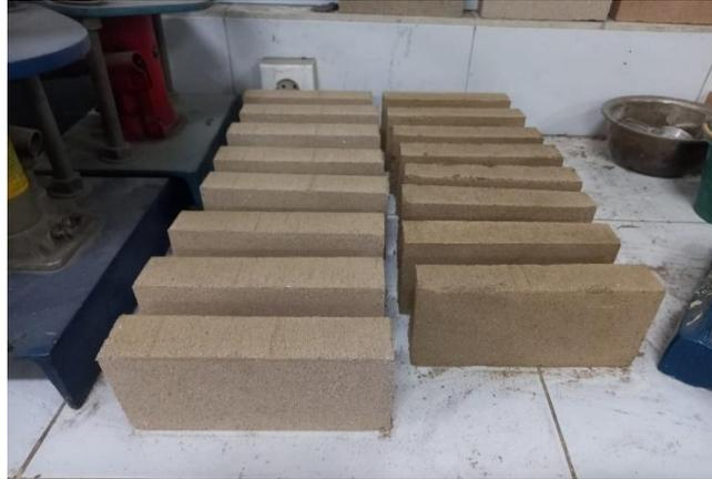
Gambar 4.29: Benda uji sifat tampak bata untuk tanah galong.
