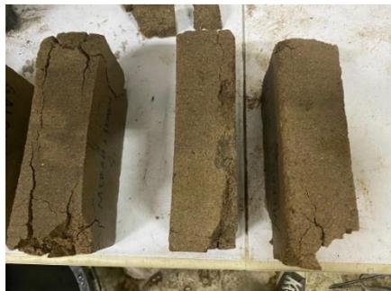
Gambar 4.6: Benda uji yang mengalami kehancuran proses pengujian dilakukan.
