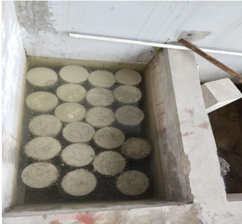
Gambar L 11 : Perendaman Benda Uji
