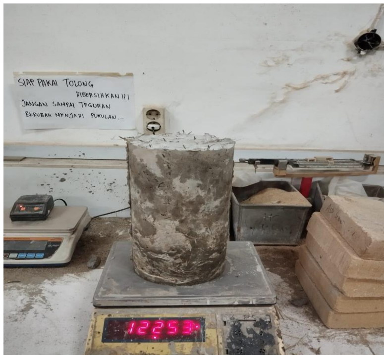
Gambar L 12 : Penimbangan Benda Uji
