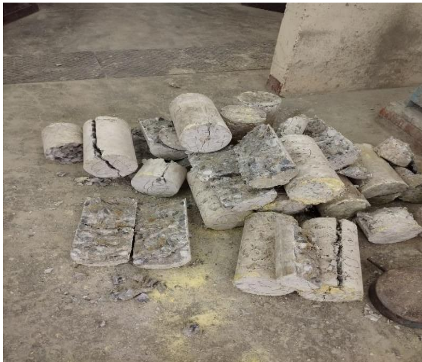
Gambar L 14 : Sampel beton setelah di uji
