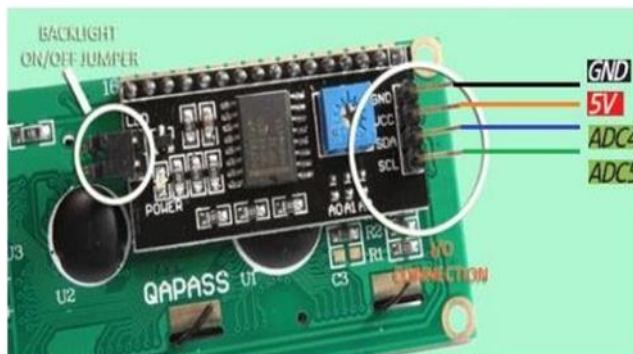
Gambar 2. 15 Konfigurasi PIN LCD
