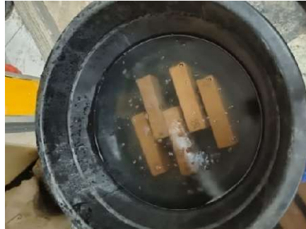
Gambar 4.5 Proses perendaman benda uji
