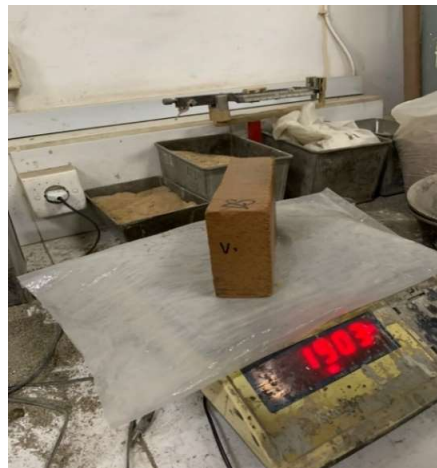
Gambar 4.6 Benda uji setelah direndam
