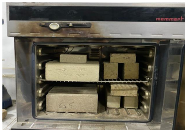
Gambar 4. 9: Proses pengovenan benda uji
