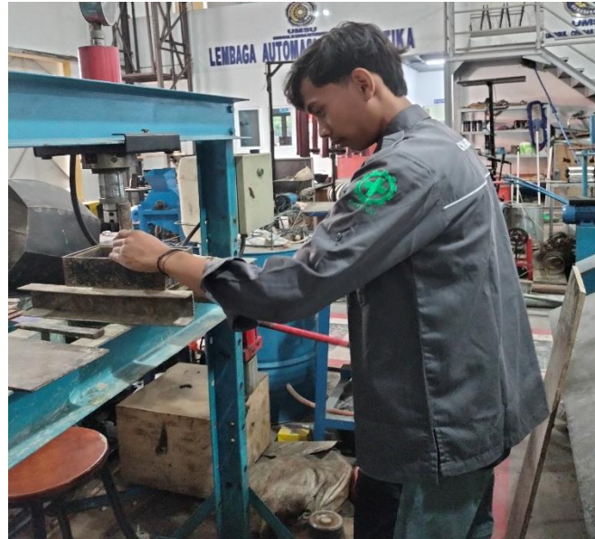
Gambar L-11 Proses Pencetakan Batu Bata
