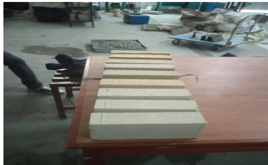
Gambar 4. 15: Pengujian sifat tampak bata
