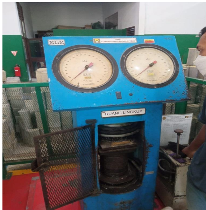
Gambar L-12 Proses Pengujian Kuat Tekan
