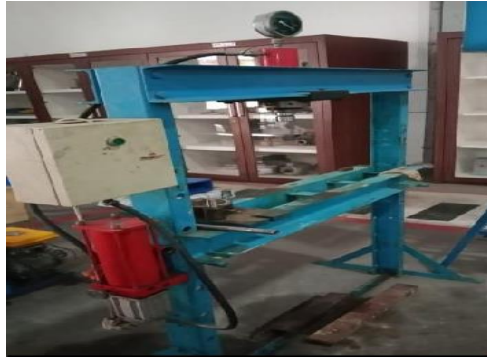
Gambar 3. 12 Mesin hidrolik press bata
