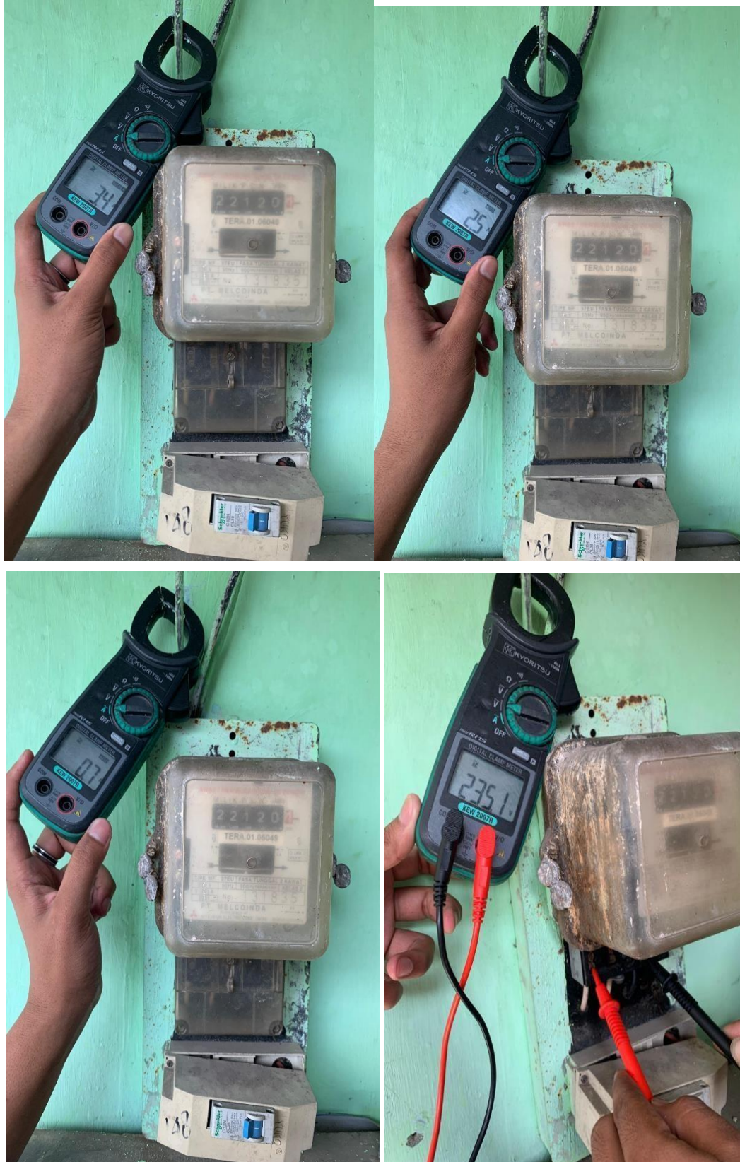
Gambar 4. 9 Pengukuran Arus dan Tegangan KWH Manual
