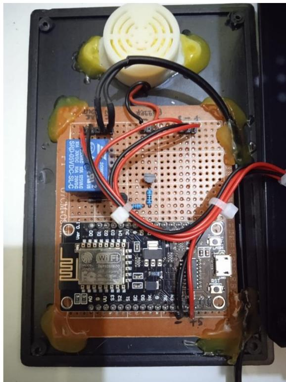
Gambar 4.1 Pengujian Mikrokontroler NodeMCU ESP8266
