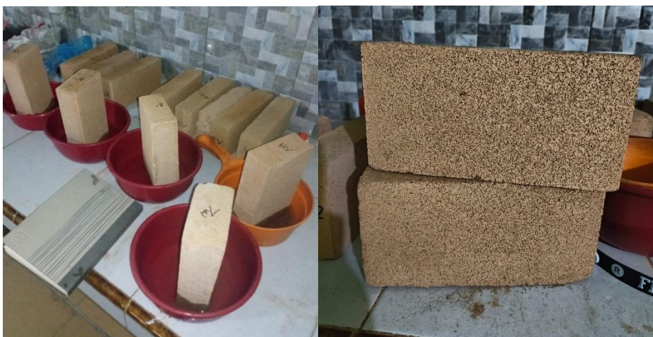
Gambar 4.9 Proses pengujian kadar garam dan hasil pengujian
