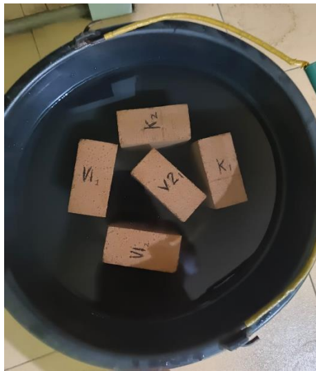
Gambar 4.12 Pengujian daya tahan bata
