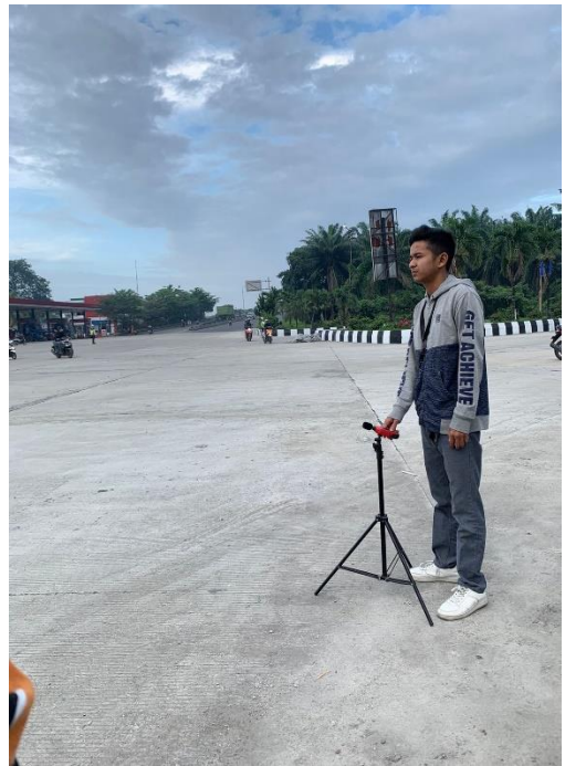
Gambar L.2: Foto saat pembacaan hasil pengukuran tingkat kebisingan lalu lintas di Bundaran KIM Percut Sei Tuan ( Lokasi 2 )
