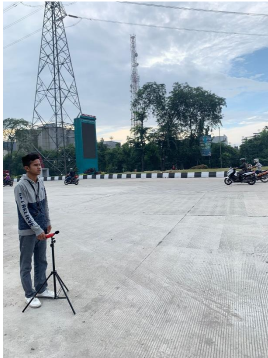
Gambar L.2: Foto saat pembacaan hasil pengukuran tingkat kebisingan lalu lintas di Bundaran KIM Percut Sei Tuan ( Lokasi 2 )
