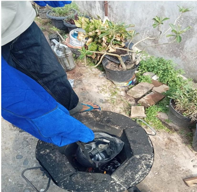
Gambar 3.8 Memasukkan bahan aluminium ke tungku lebur
