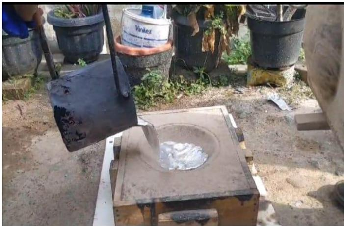
Gambar 4.13 Proses Penuangan
