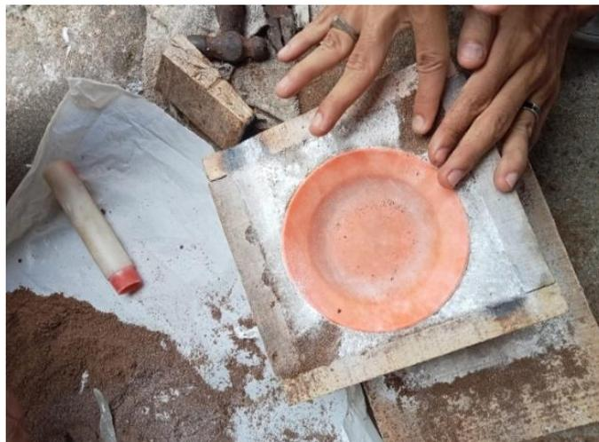
Gambar 4.10 Proses pencetakan piring
