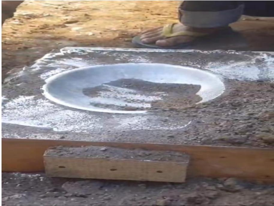
Gambar 3.15. Proses pembongkaran cetakan
