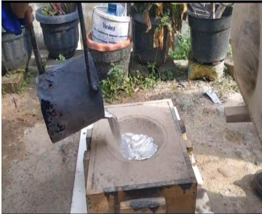
Gambar.3.14 Proses penuangan
