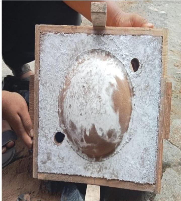
Gambar 4.11 Proses pengangkatan cetakan
