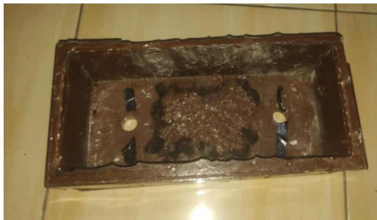
Gambar 4.15 Setelah Pengujian pada variasi campuran 70% resin dengan 30% serbuk keramik.
