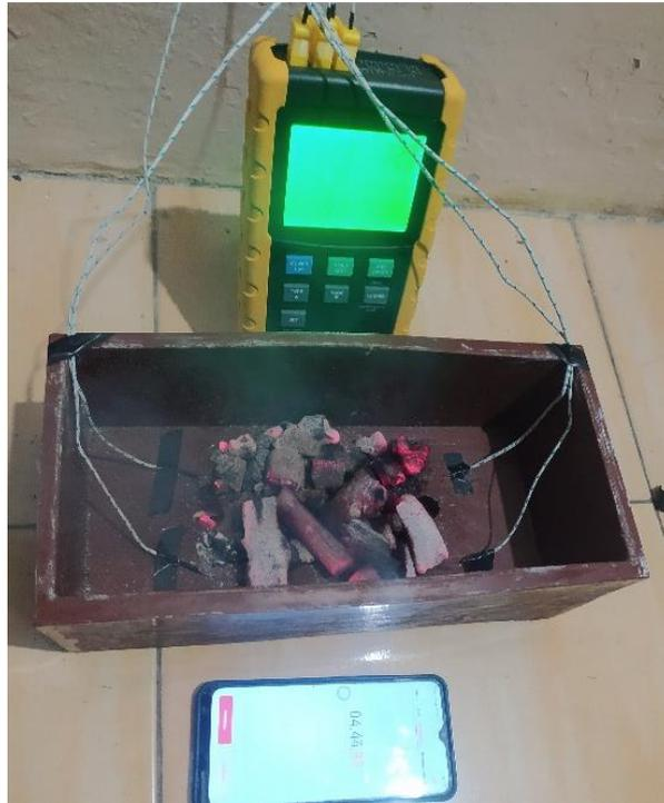
Gambar 4.12 Pengujian pada variasi campuran 80% resin dengan 20% serbuk keramik.
