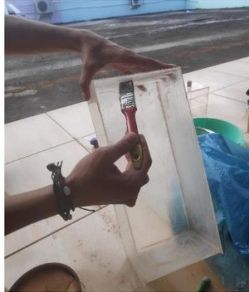
Gambar 4.2 pengolesan mirror glaze pada cetakan akrilik.
