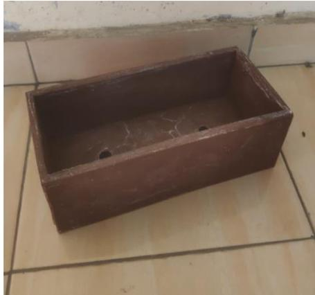
Gambar 4.9 Hasil Cetakan variasi 90% resin dengan 10% serbuk keramik.
