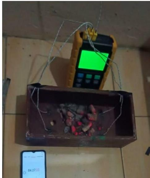
Gambar 4.10 Pengujian pada variasi campuran 90% resin dengan 10% serbuk keramik.
