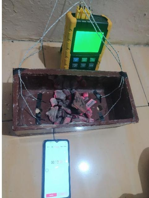
Gambar 4.14 Pengujian pada variasi campuran 70% resin dengan 30% serbuk keramik.
