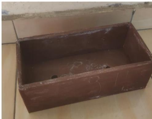
Gambar 4.7 Hasil Cetakan variasi 70% resin dengan 30% serbuk keramik.
