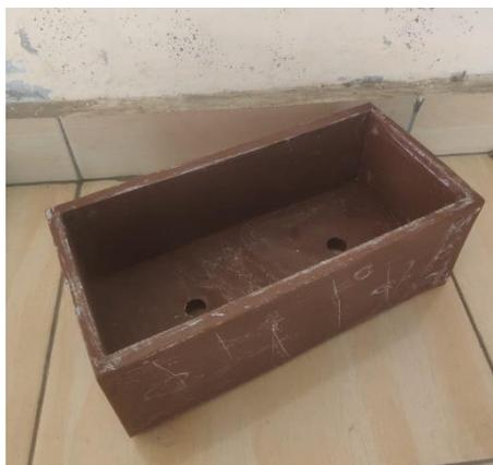
Gambar 4.8 Hasil Cetakan variasi 80% resin dengan 20% serbuk keramik.
