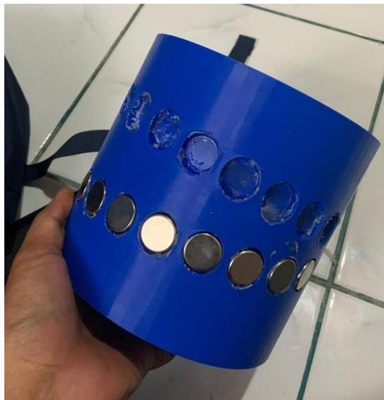
Gambar 4.3 Pemasangan Magnet
