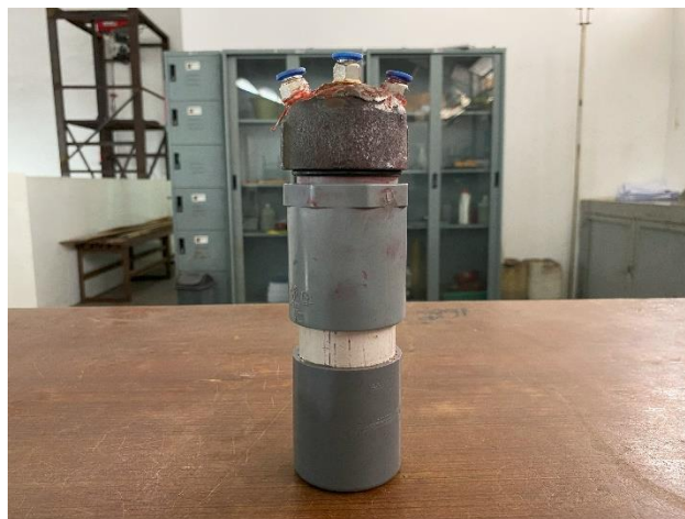
Gambar 4.24 Hasil Pembuatan Tabung Penyimpanan Cat
