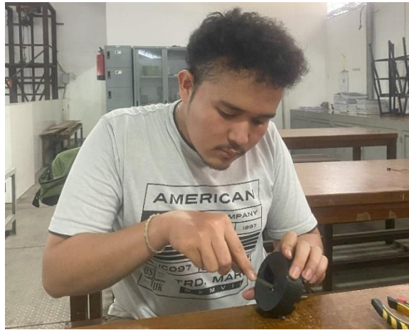
Gambar 4.12 Proses Penghalusan Menggunakan Kikir
