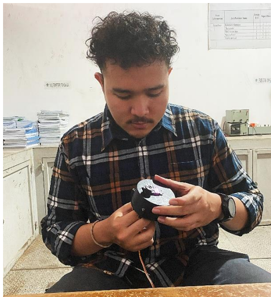
Gambar 4.14 Pemasangan Motor Servo Ke Dalam Base
