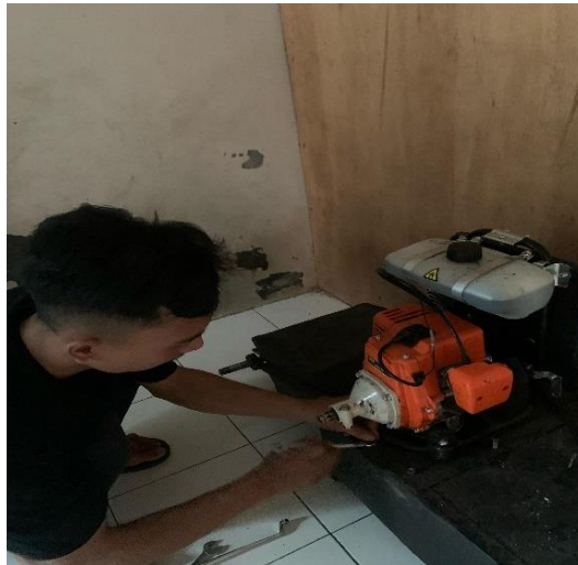
Gambar 4.15 Proses Pemasangan Motor Penggerak
