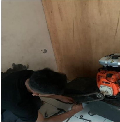
Gambar 4.16 Proses Pemasangan Sprocket dan Rantai
