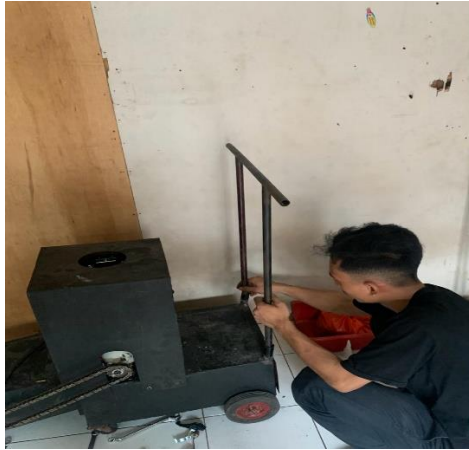
Gambar 4.18 Proses Pemasangan Batang Pendorong
