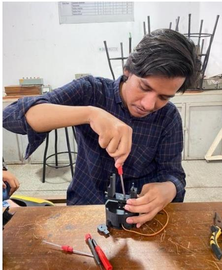
Gambar 4.21 Pemasangan Base Lengan Robot
