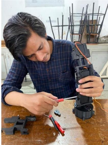
Gambar 4.22 Pemasangan Upper Base dan *Link*
