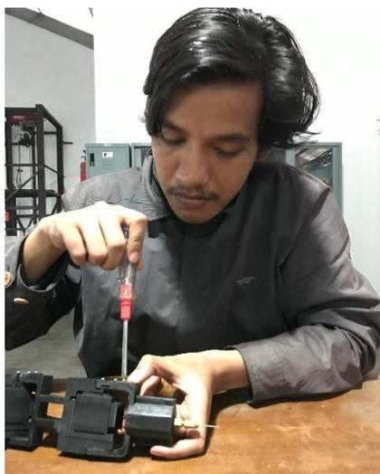
Gambar 4.23 Pemasangan *End-effector* Bor *Drilling*
