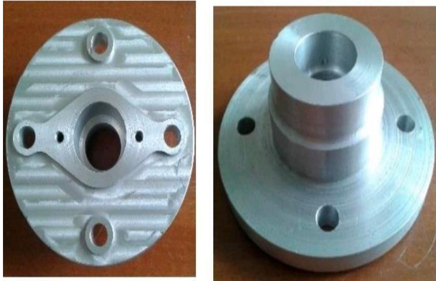
Gambar 2.3 Bracket aluminium pada spacer (Raharjo et al., 2018)
