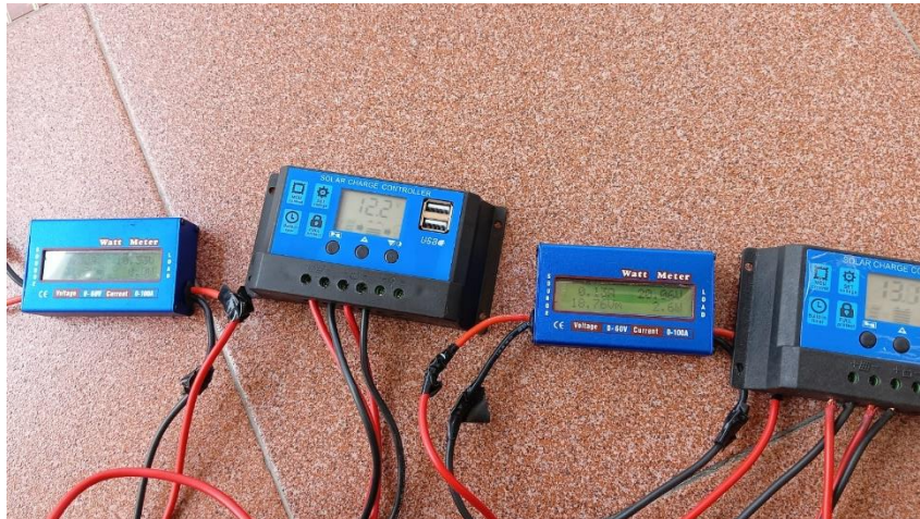
Gambar 4. Pengukuran Arus dan Tegangan Output
