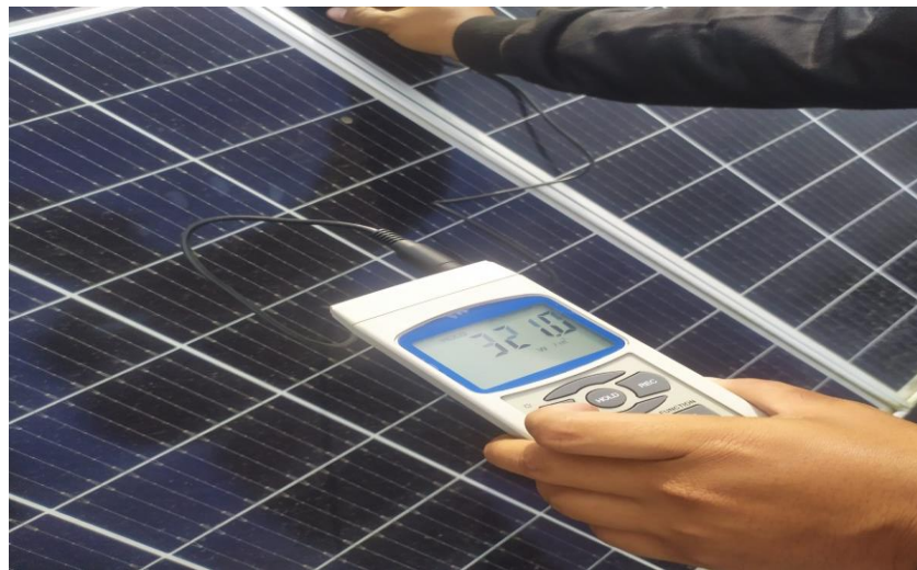
Gambar 5. Pengukuran Intensitas Radiasi Matahari
