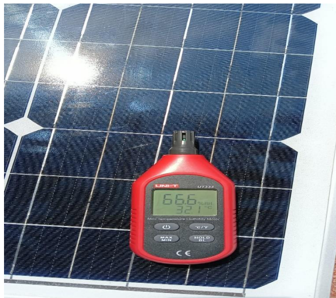
Gambar 3. Pengukuran suhu sekitar panel surya
