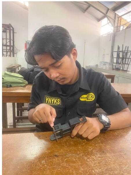
Gambar 4.17 Penghalusan Komponen Lengan Robot
