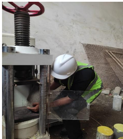
Gambar.L 27. Proses pengujian benda uji dengan menggunakan mesin kuat tekan
