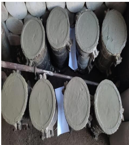
Gambar.L 21. Beton dalam wadah cetakan silinder 15x30cm
