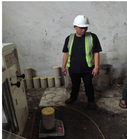
Gambar.L 26. Persiapan sebelum memulai pengujian kuat tekan
