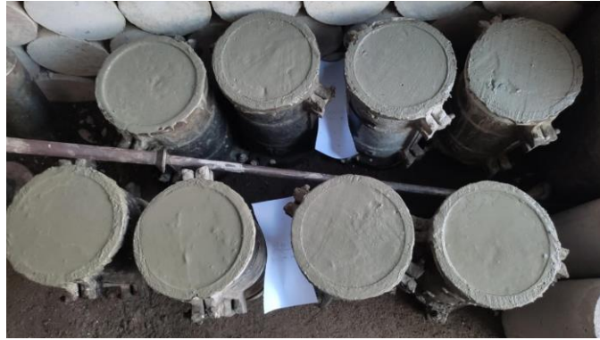
Gambar 3.5 Pembuatan beton yang sudah didalam cetakan silinder 15x30 cm
