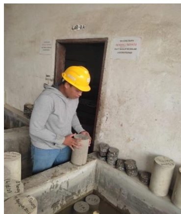
Gambar 3.7 Perawatan ( curing ) pada bak perendaman
