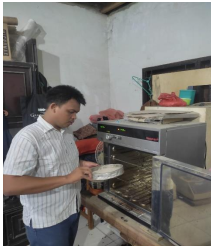
Gambar.L 20. Proses peletakan sampel agregat halus ke dalam oven
