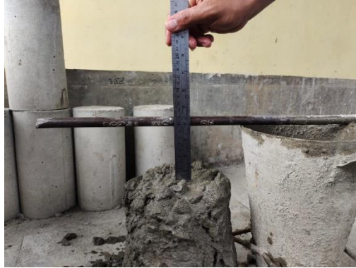
Gambar 3.6 Proses pengujian slump test
