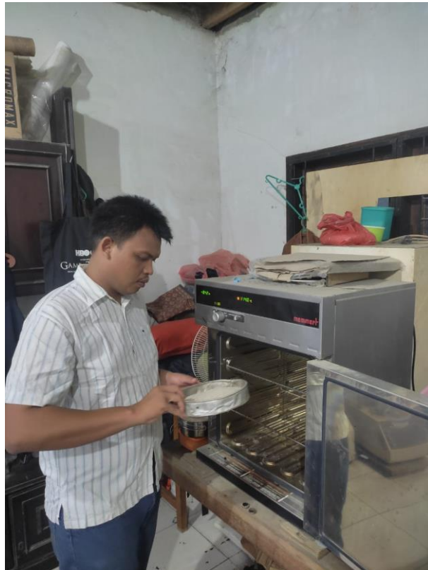
Gambar 3.3 Pelaksanaan peletakan agregat halus pada oven
