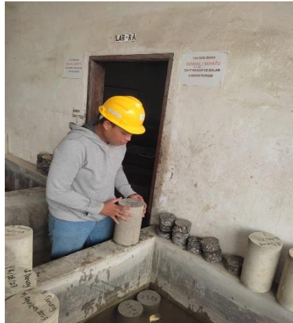
Gambar.L 22. Proses peletakan benda uji pada bak perendaman
