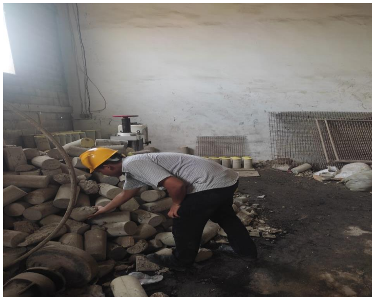
Gambar 3.2 Limbah beton dari batching plant PT. Rapi Arjasa
