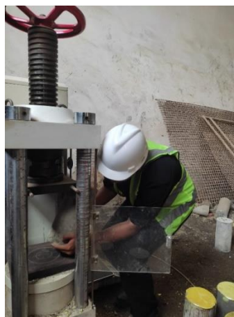
Gambar 3.8 Pengujian kuat tekan ( compression test )
