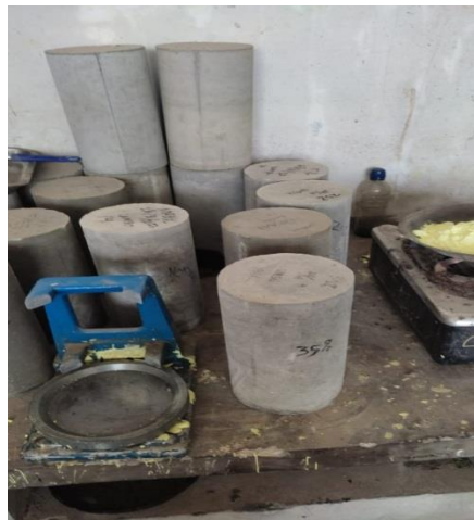
Gambar.L 24. Benda uji yang sudah dikeluarkan dari bak perendaman
