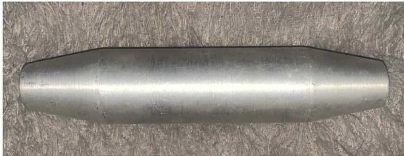
Gambar 3. 18 Silinder dari pemanfaatan Limbah Permesinan aluminium
