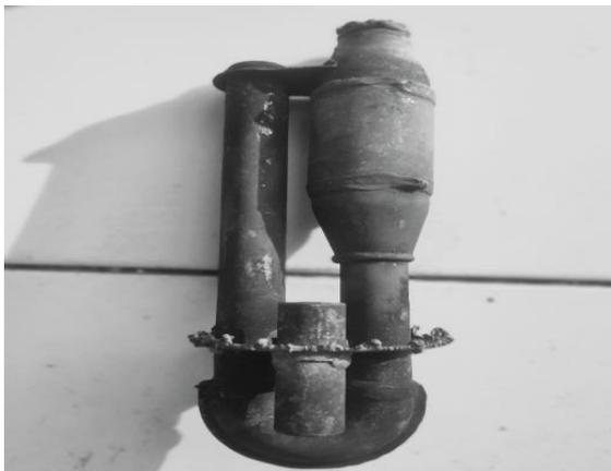
Gambar 3.11 Bagian dalam resonator knalpot standar
