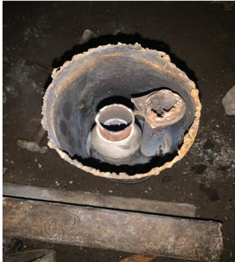
Gambar 3.25. Knalpot modifikasi menggunakan silinder aluminium 40mm
