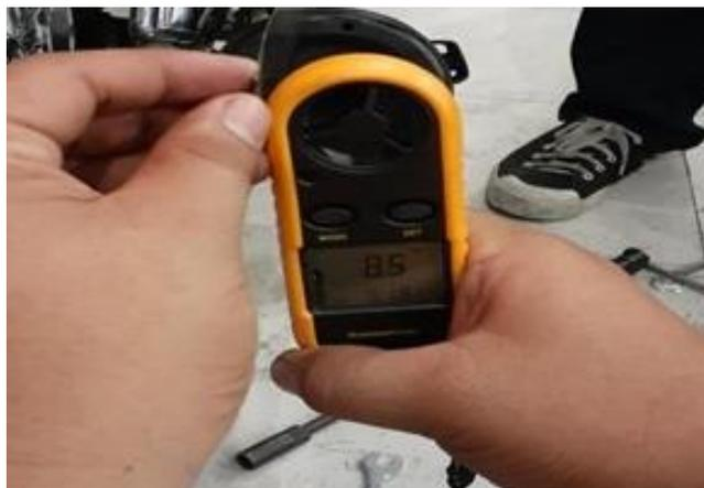
Gambar 3.28 Pengukuran kecepatan angin gas buang
