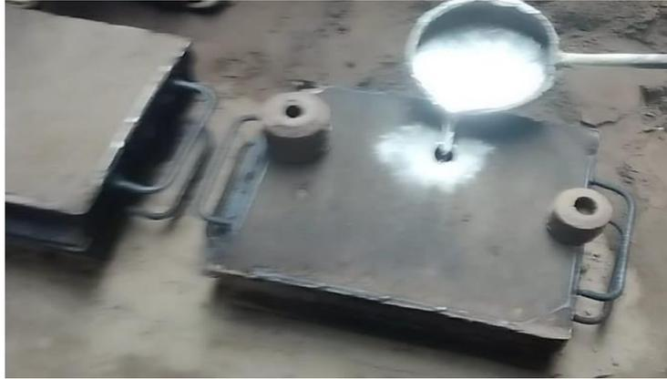
Gambar 3. 15 Penuangan logam cair kedalam cetakan
