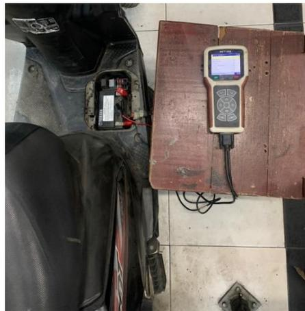
Gambar 3.22 Pengukuran rpm dengan *Fi Scanner*
