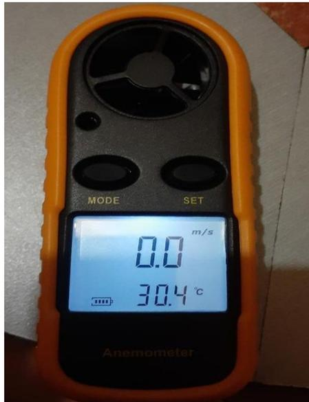
Gambar 3. 7 Anemometer
