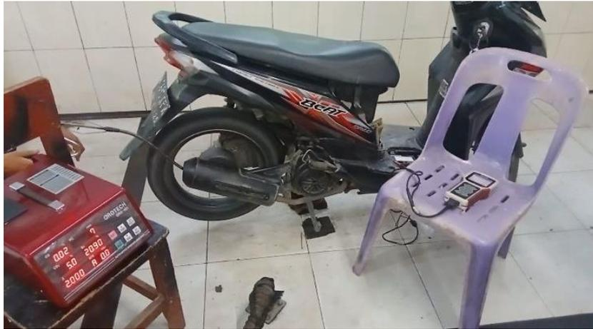
Gambar 3.29 Pengujian pada knalpot modifikasi
