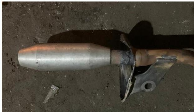
Gambar 3.30. Knalpot modifikasi menggunakan silinder berongga 44mm
