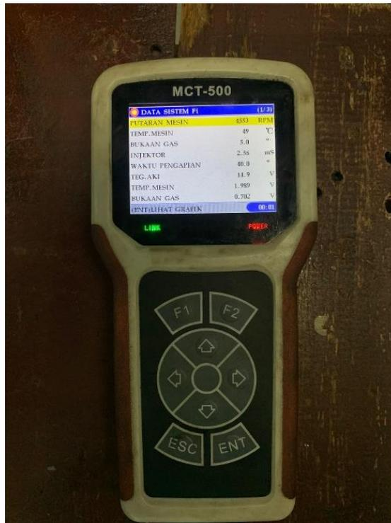
Gambar 3.27 Pengukuran rpm dengan *Fi scanner*
