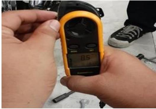
Gambar 3.23 Pengukuran kecepatan angin gas buang
