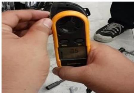
Gambar 4.20 Pengukuran kecepatan angin gas buang
