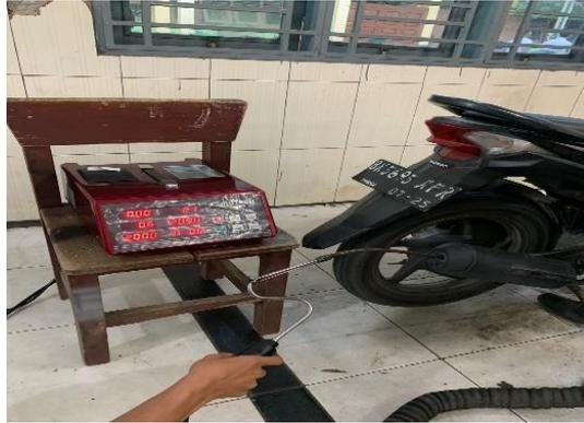
Gambar 4.21 Pengujian pada knalpot modifikasi
