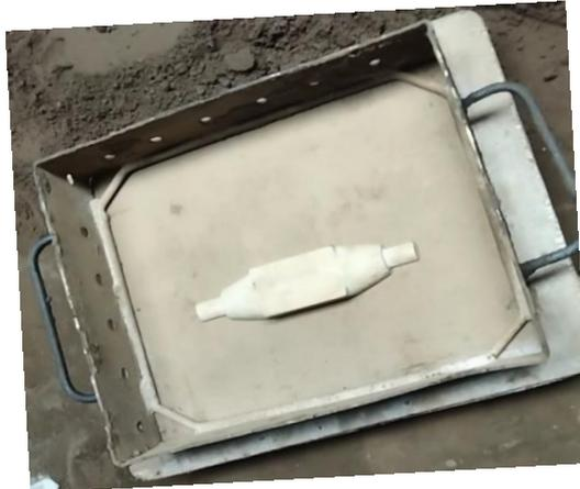
Gambar 4.5 Pembuatan Cetakan
