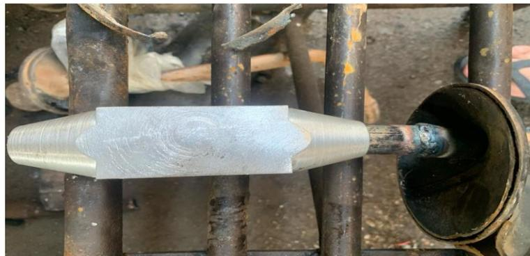
Gambar 4.17 Knalpot modifikasi menggunakan pipa berongga 44mm
