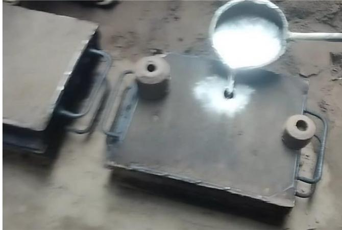
Gambar 4.7 Penuangan logam cair kedalam cetakan
