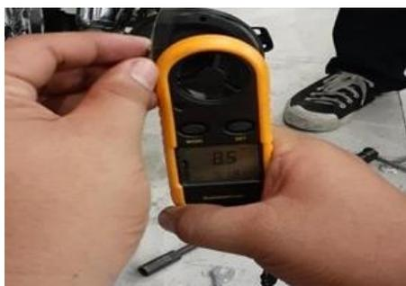
Gambar 4.15 Pengukuran kecepatan angin gas buang
