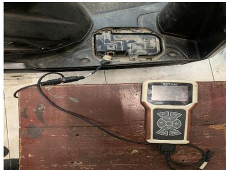
gambar 4.14 Pengukuran rpm dengan *Fi Scanner*
