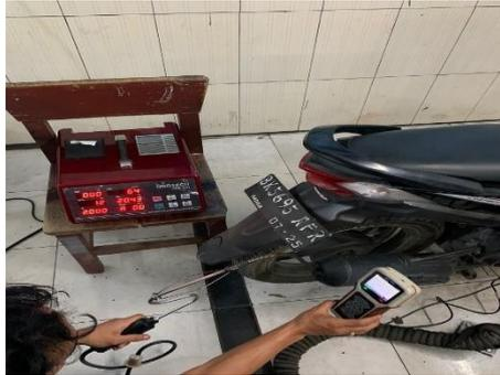
Gambar 4.16 Pengujian emisi gas buang dengan menggunakan Gas Analyzer
