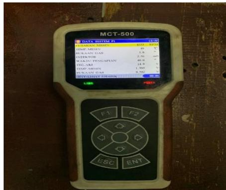
Gambar 4.19 Pengukuran rpm dengan *Fi scanner*
