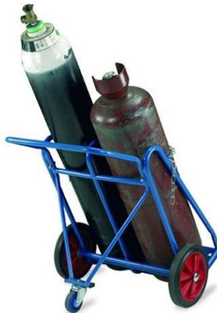
Gambar 3.3. Mesin las Asetilin
