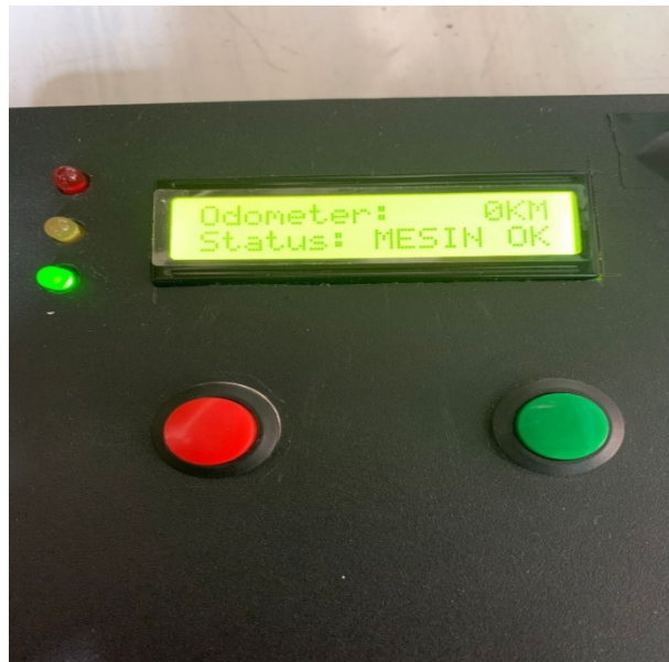
Gambar 4.2 Kontruksi Tampilan LCD Serta Led dan Tombol
