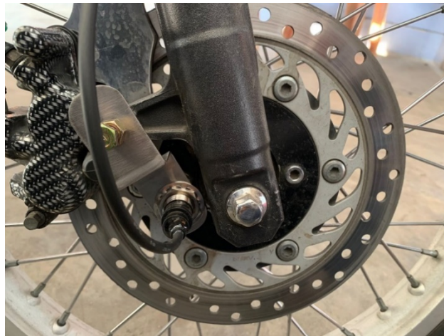
Gambar 4.3 Kontruksi Peletakan Sensor Proxiymity
