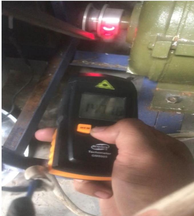
Gambar 4. 1 Pengukuran Kecepatan Putar Pada Motor Pemas Tebu
