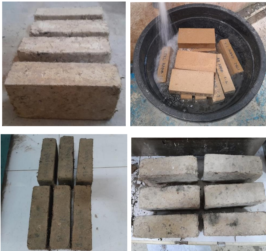
Gambar 4.14: Proses uji daya tahan dengan metode drying dan wetting
