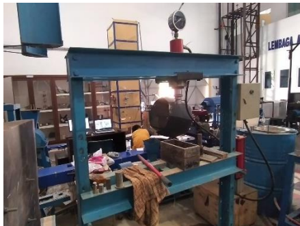
Gambar 3.9: Mesin cetak bata dengan pompa hidrolik
