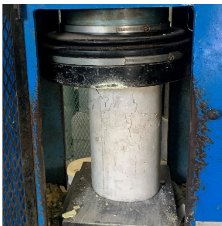
Gambar L-38: Pengujian kuat tekan
