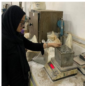
Gambar 3.6: Pengujian berat isi dengan cara lepas
