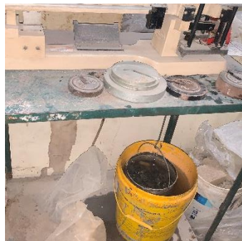
Gambar 3.5: Pengujian berat jenis agregat kasar
