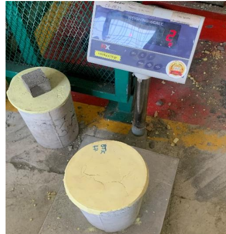
Gambar L-37: Penimbangan benda uji
