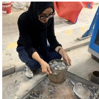
Gambar 3.8: Pengujian berat isi dengan cara goyang
