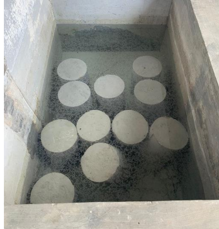
Gambar L-35: Perendaman benda uji
