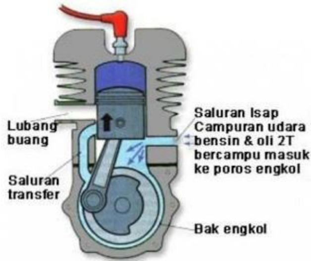
Gambar 2.14. Cara Kerja Mesin 2 Tak
