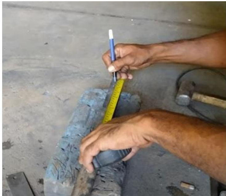
Gambar 4.20. Pengukuran Plat Mata Pisau
