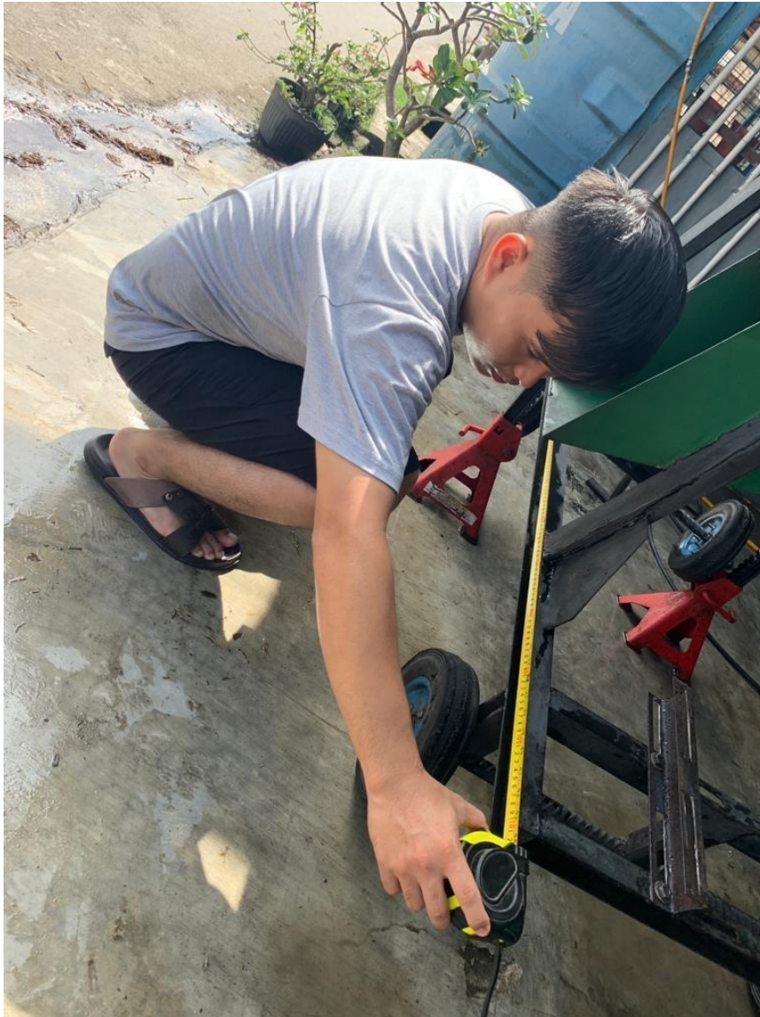
Gambar 4.10. Proses Penyatuan Rangka
