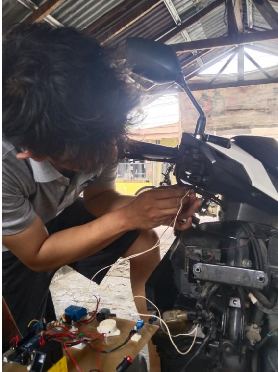
Gambar 4.12 Menghubungkan Kabel Output Modul Ke Swith Stater
