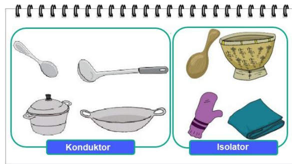
Gambar II. 1 Bahan Konduktor dan Isolator
