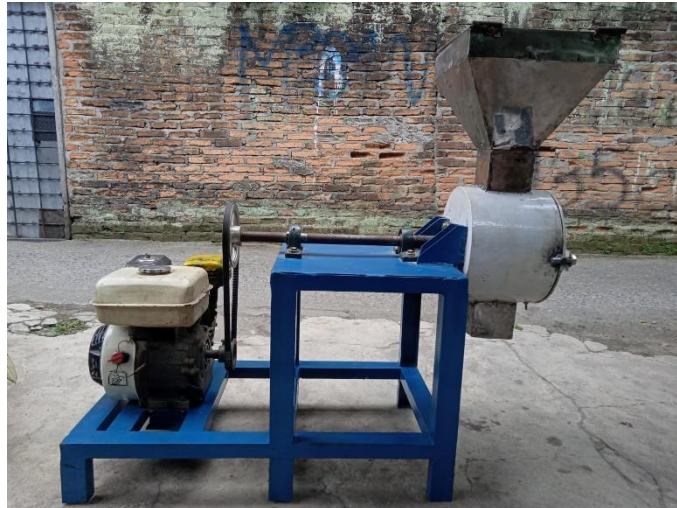
Gambar 3.1 Mesin penggiling biji durian
