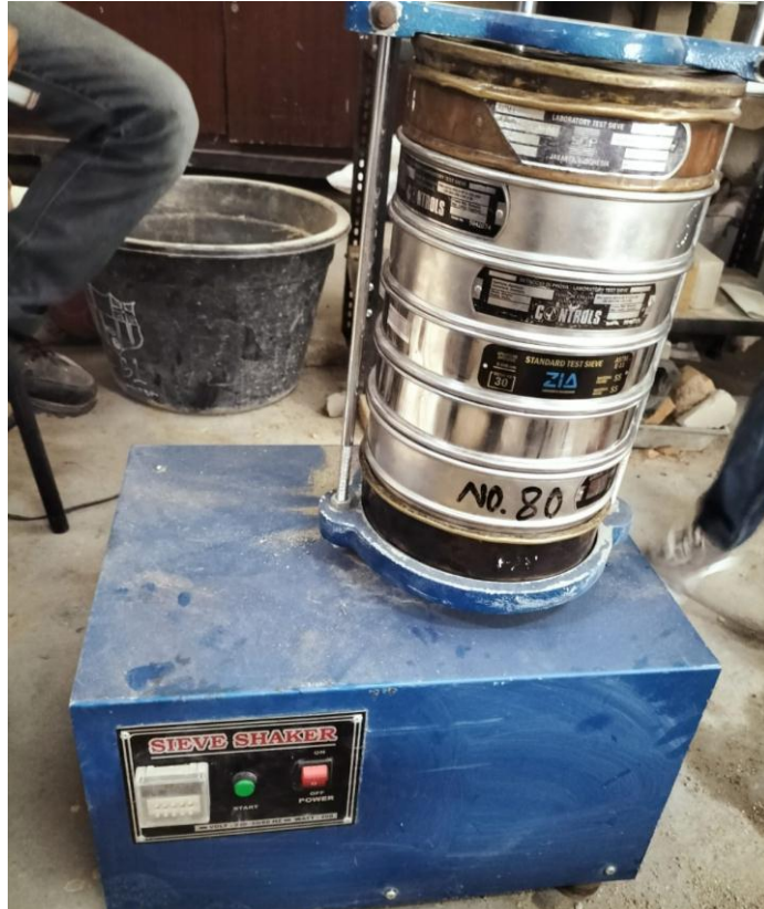
Gambar 7.6: Pengujian analisa saringan
