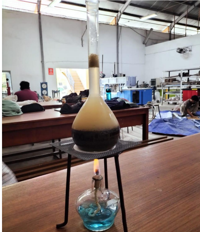
Gambar 7.5: Pengujian berat jenis agregat
