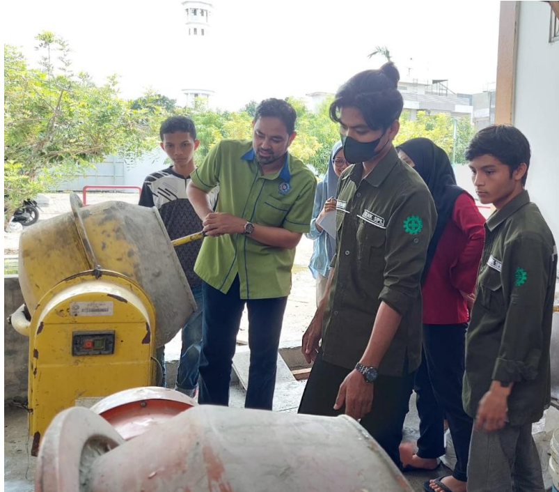
Gambar 7.9: Pembuatan benda uji beton
