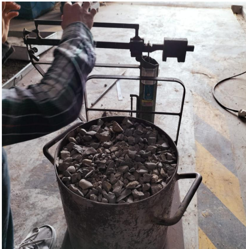
Gambar 7.4: Pengujian berat isi agregat
