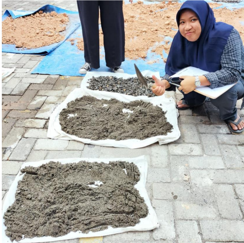
Gambar 7.3: Pengeringan agregat sampai kondisi SSD
