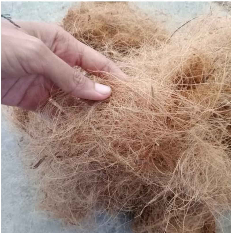
Gambar 7.2: Sabut kelapa sebagai serat pada campuran beton
