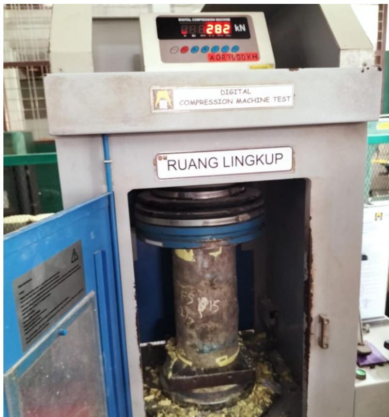
Gambar 7.14: Pengujian kuat tekan beton
