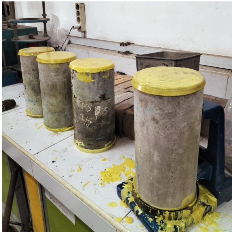
Gambar 7.12: Pemasangan capping pada benda uji
