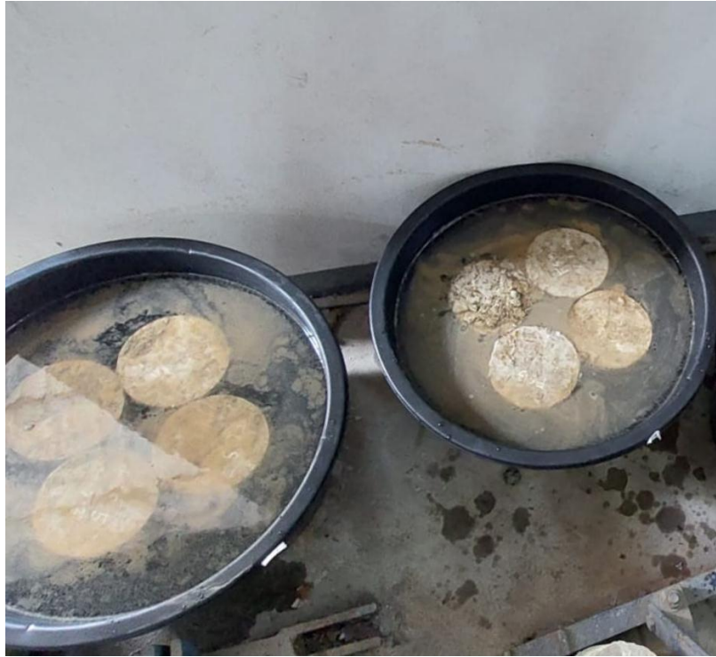
Gambar 7.11: Perendaman benda uji pada air garam
