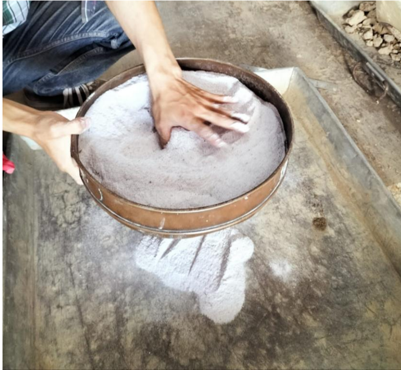
Gambar 7.1: Abu sekam padi lolos saringan No.100
