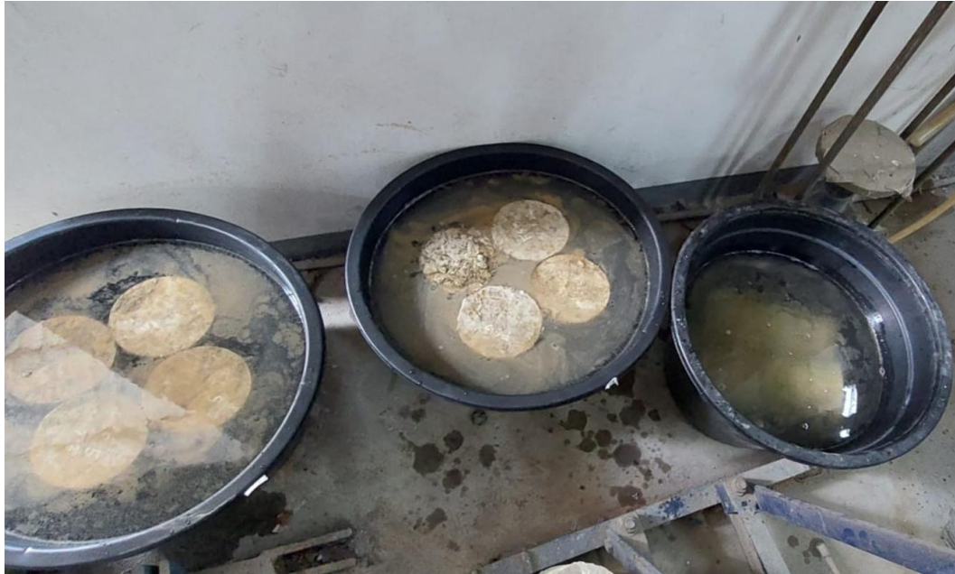
Gambar 4.7: Proses perendaman benda uji terhadap larutan garam sulfat
