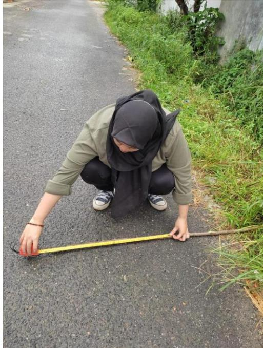
Gambar.L 7. Pengukuran titik basah pada tampungan drainase.
