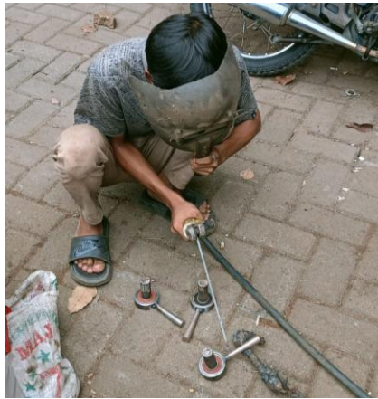
Gambar 4.36 proses penyambungan rumah bearing dengan as
