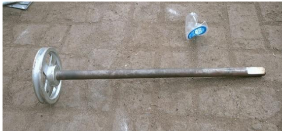
Gambar 4.22 Hasil Dari Pembubutan dan Sudah dipasang Pully
