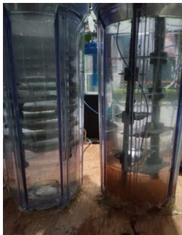
Gambar 4.1 Plat titanium dan stainless steel di dalam tabung reaktor
