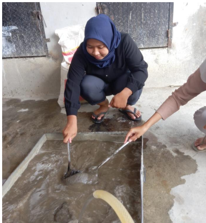
Gambar L.6 : Penyucian agregat dari lumpur dan kotoran
