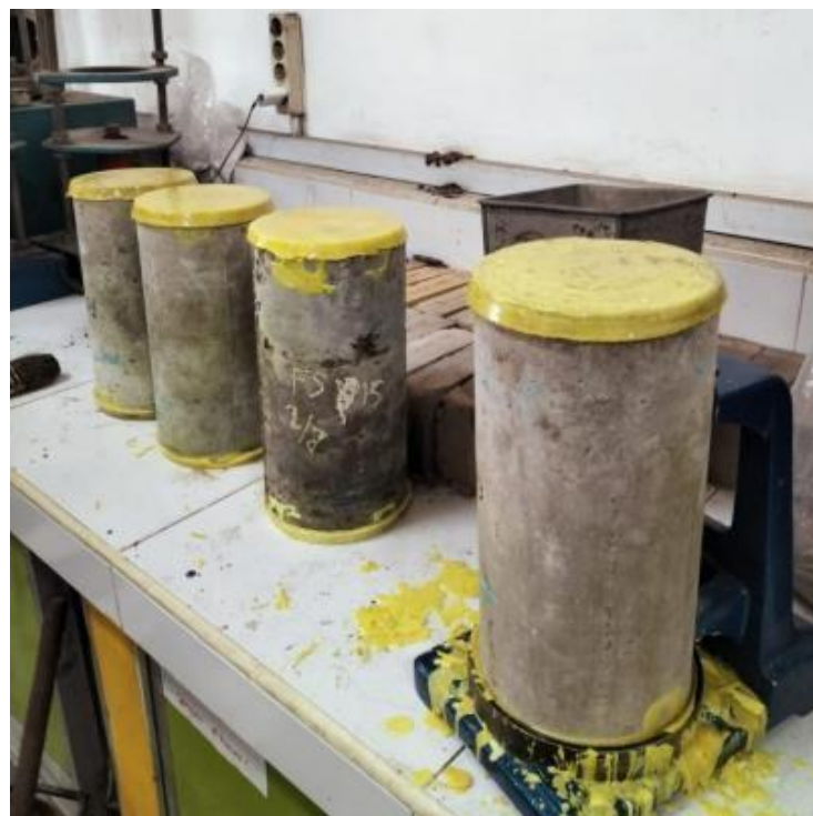
Gambar L. 11 : Pemasangan capping pada benda uji
