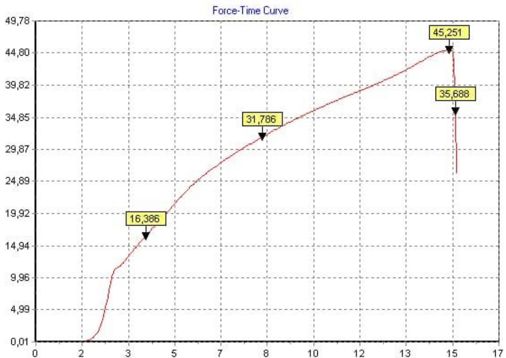
Gambar 4. 8 curva gaya terhadap waktu beton normal
