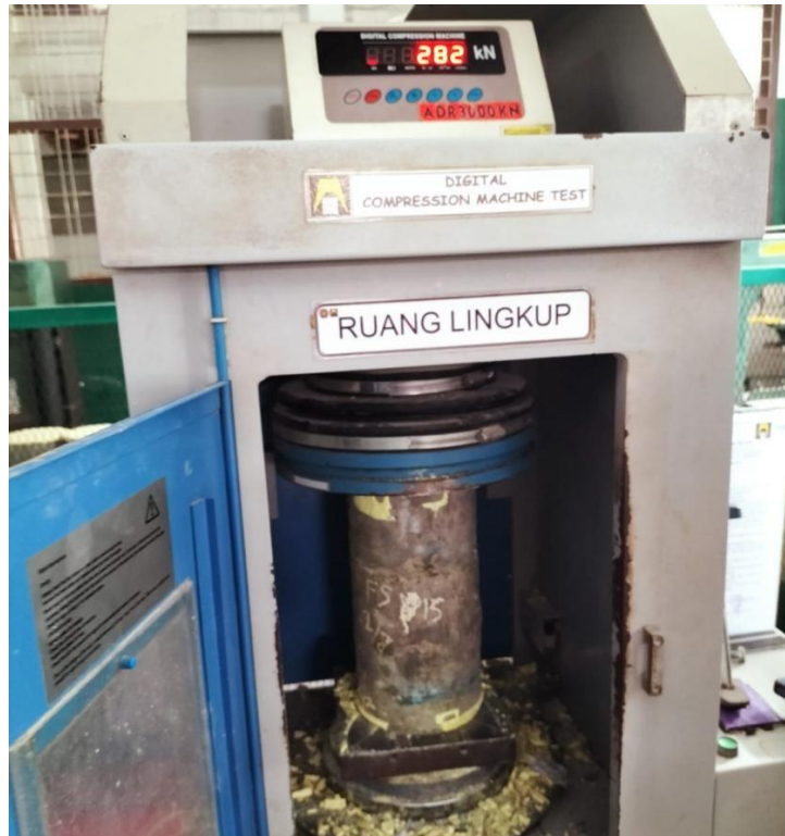
Gambar L.12: Pengujian kuat tekan
