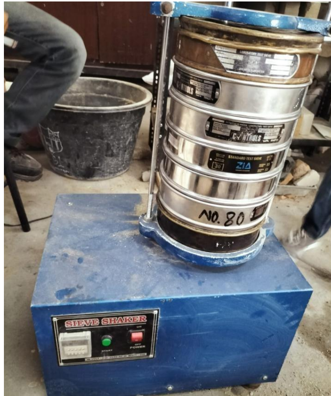
Gambar L.5 : Pengujian analisa saringan
