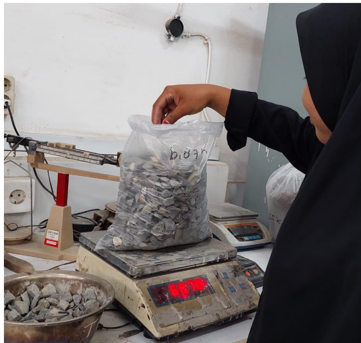
Gambar L.8 : Penimbangan agregat sesuai takaran
