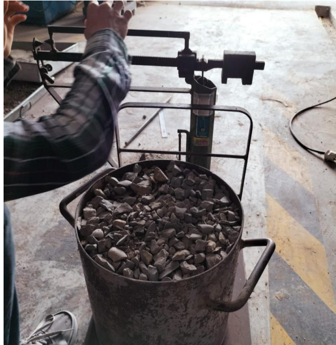
Gambar L.4 : pengujian berat isi agregat
