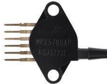
Gambar 2.3 Skematik Sistem Sensor Tekanan MPX5700AP
