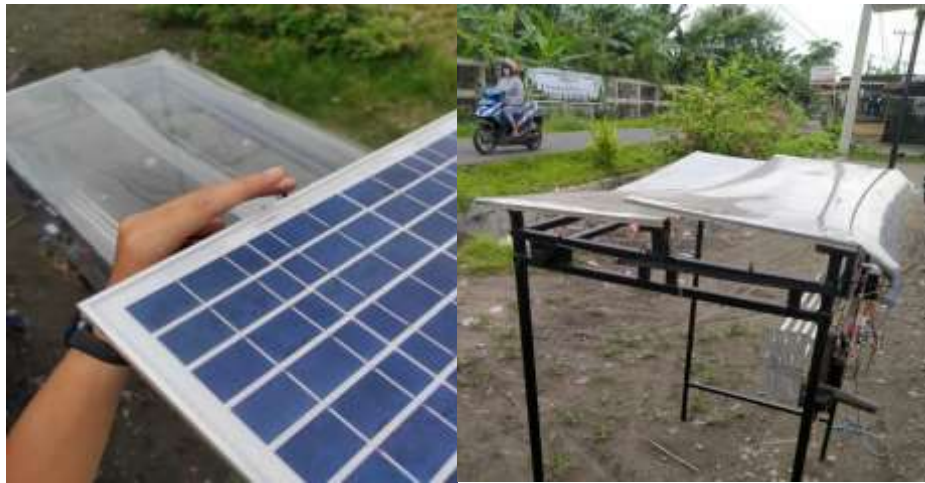
Gambar 4.16 Pengujian sensor LDR pada kondisi tidak menerima cahaya (mendung), atap dan jemuran akan tertutup
