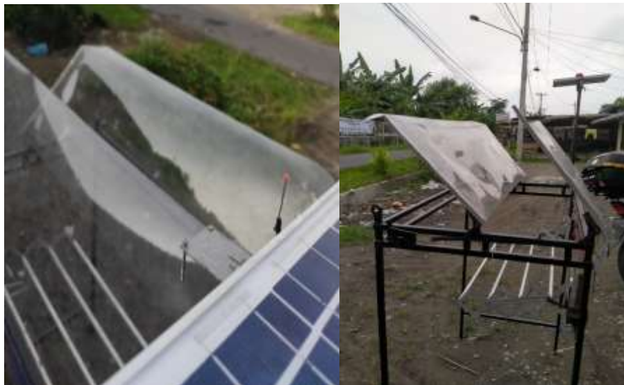
Gambar 4. 17 Pengujian sensor LDR saat kondisi cuaca sedang normal, atap dan jemuran akan terbuka
