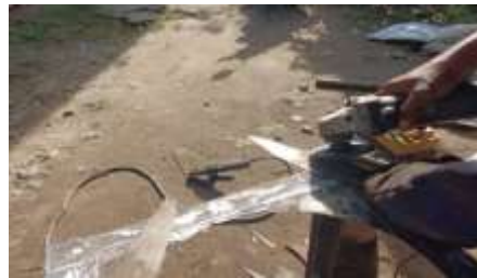
Gambar 3.31. Pemotongan Plat Stainless dan pembentukan Mata pisau
