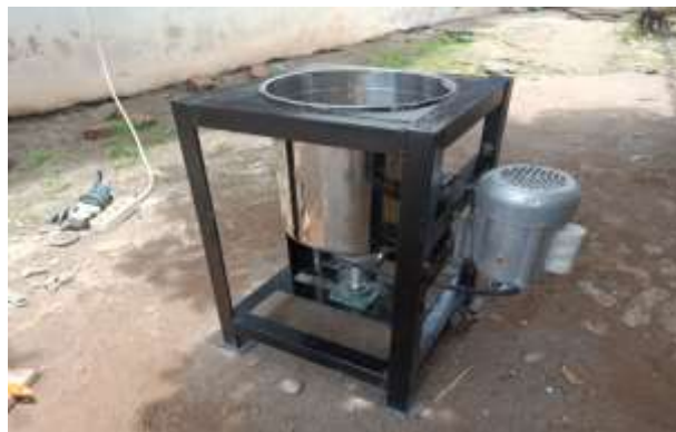
Gambar 4.20. Hasil Pembuatan Mesin Penggiling Daging
