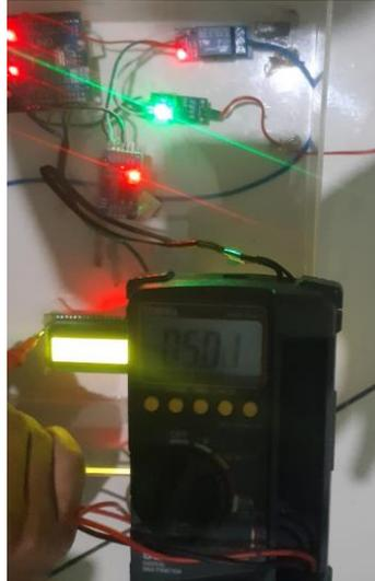
**Gambar 4.3** Pengujian Sensor Terhadap Tampilan LCD
