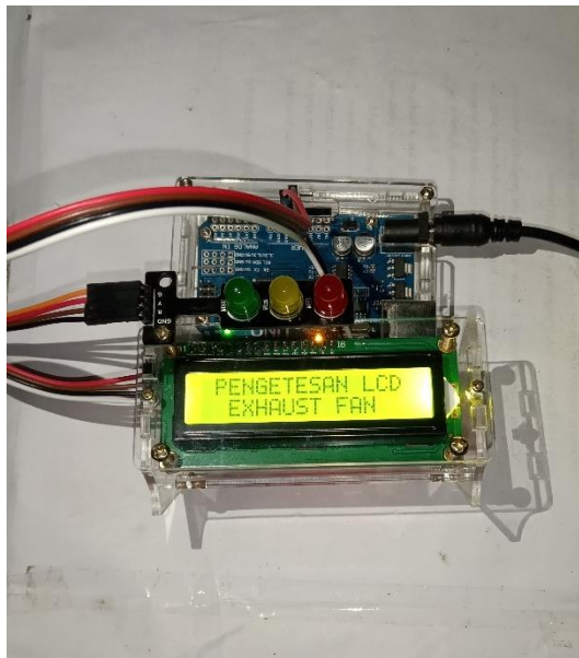
Gambar 4.10 Pengujian LCD 16x2 I2C
