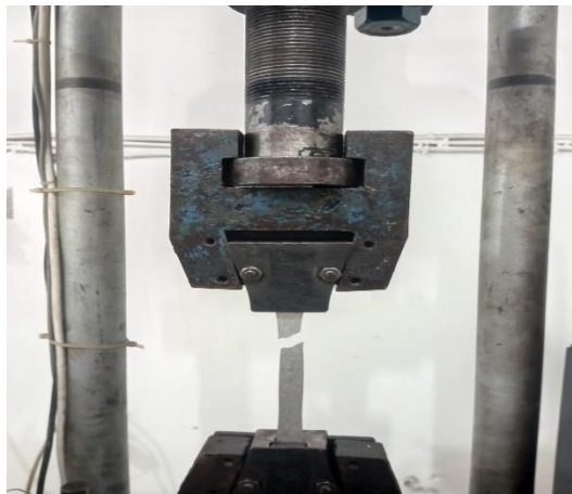
Gambar 4.25 Spesimen percobaan keempat Setelah Uji Tarik
