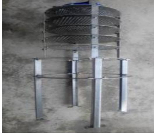
Gambar 2.8 Kerangka Pendukung Tower support (Effendi & Saputra, 2020)
