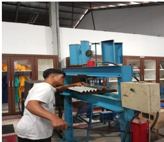
Gambar 4.15 pembentukan pola bergelombang
