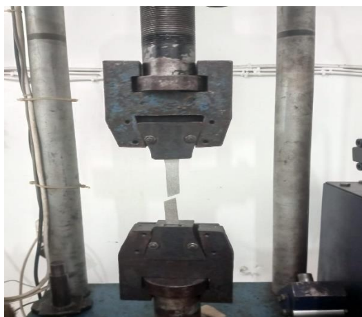
Gambar 4.21 Spesimen Percobaan kedua Setelah Uji Tarik
