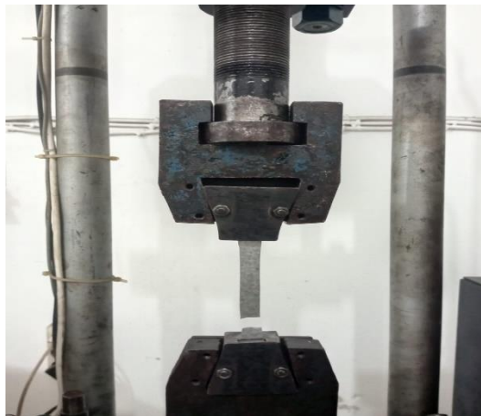
Gambar 4.29 Spesimen percobaan ke enam Setelah Uji Tarik
