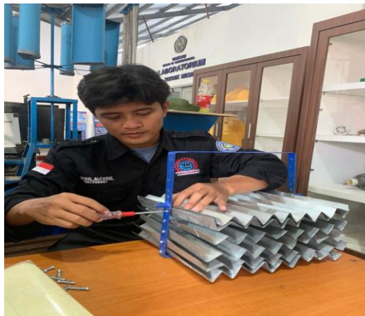
Gambar 4.17 Perakitan fill film bergelombang
