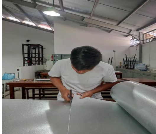
Gambar 4.14 Menggunting plat galvalum
