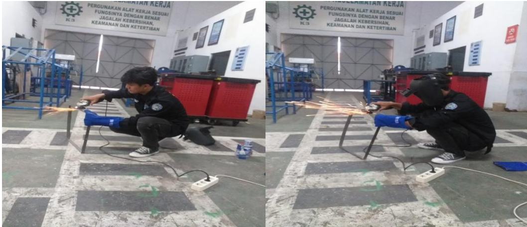
Gambar 4.8. Pengamplasan Bingkai fill
