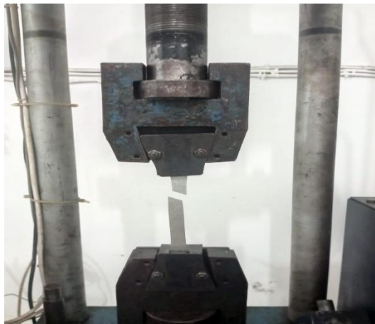
Gambar 4.19 Spesimen percobaan pertama setelah Uji Tarik
