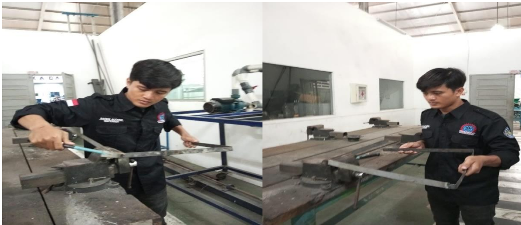
Gambar 4.5 proses pembentukan persegi bingkai fill
