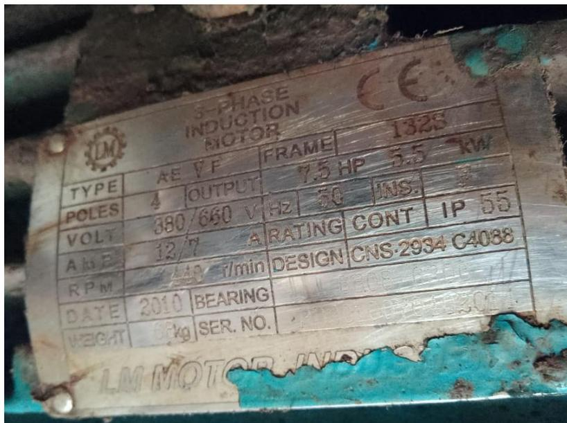
Gambar 2. 7 Spesifikasi Motoran *Transfer Carriage Hydraulic System*
