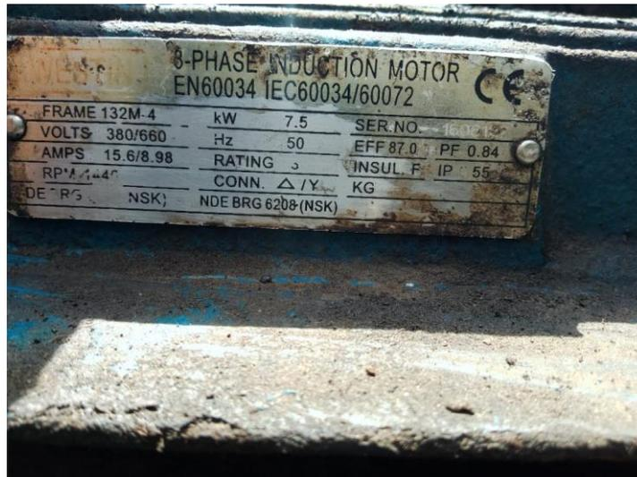
Gambar 2. 9 Spesifikasi Motoran *Sterilizer Fruit Bunch Conveyor*
