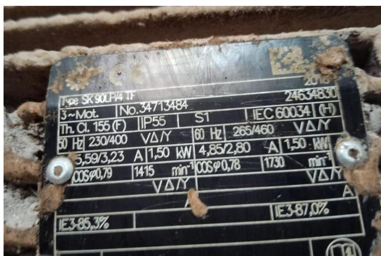
Gambar 2. 34 Spesifikasi Motoran *Solid Conveyor*
