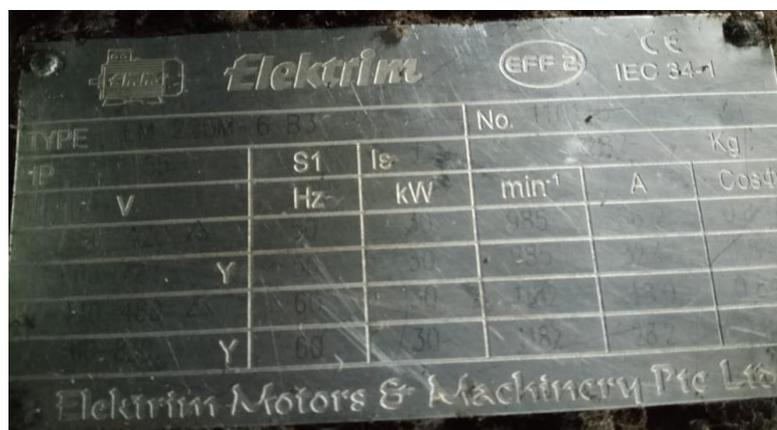
Gambar 2. 15 Spesifikasi Motoran *Digester*
