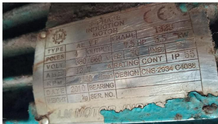
Gambar 2. 11 Spesifikasi Motoran *Fruit Bunch Inclined Screper*
