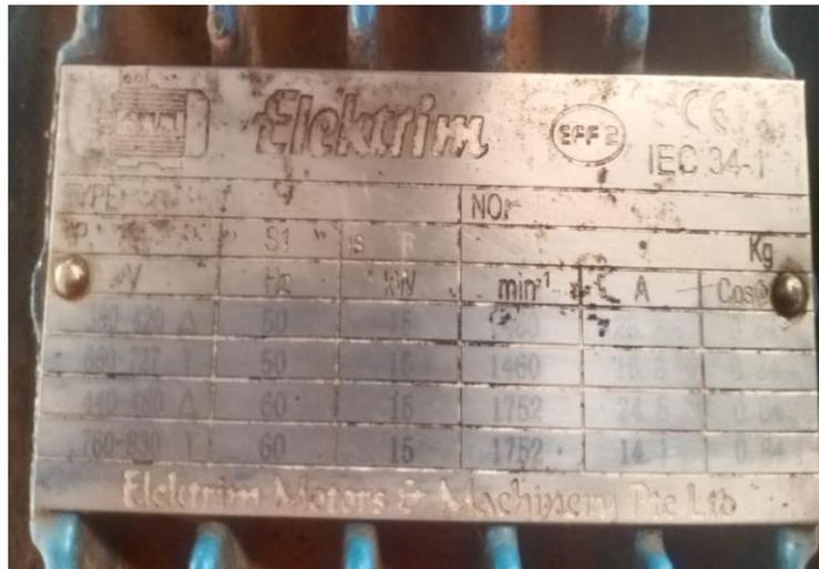
Gambar 2. 27 Spesifikasi Motoran *Kernel Silo Heater Fan*
