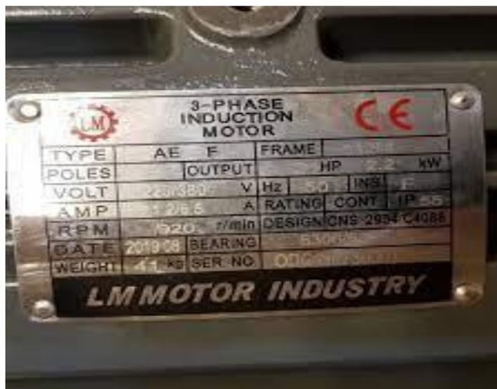
Gambar 2. 31 Spesifikasi Motoran *Oil Feed Pump*
