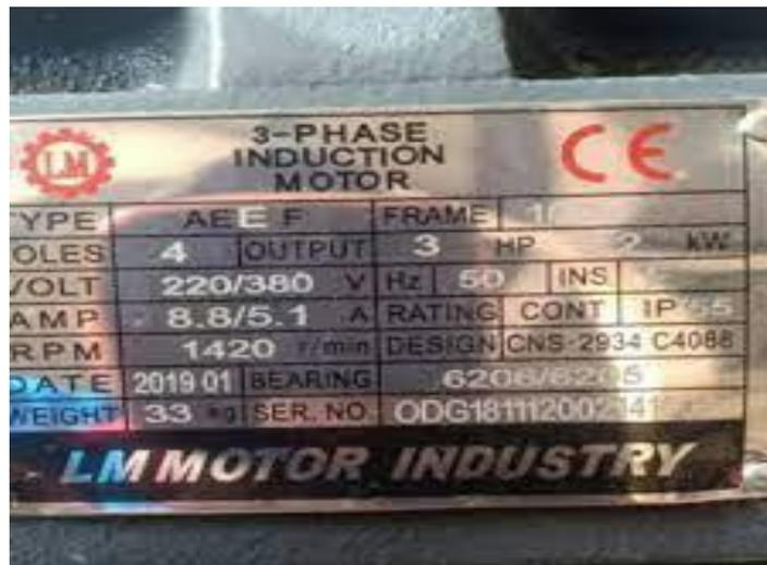
Gambar 2. 29 Spesifikasi Motoran *Vibrating Screen*
