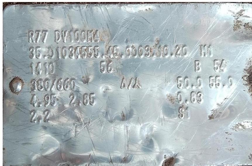
Gambar 2. 24 Spesifikasi Motoran *Cracked Mixture Elevator*
