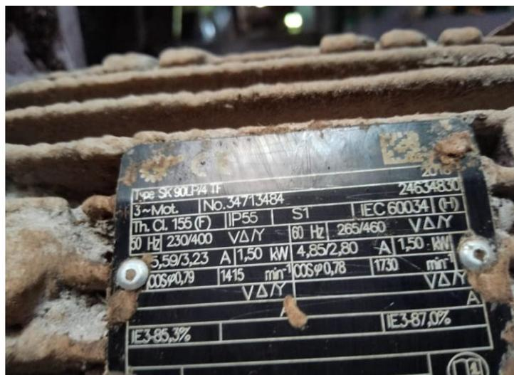
Gambar 2. 6 Spesifikasi Motoran Air *Compressor*
