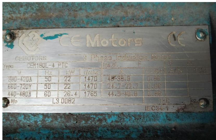
Gambar 2. 21 Spesifikasi Motoran LTDS Fan
