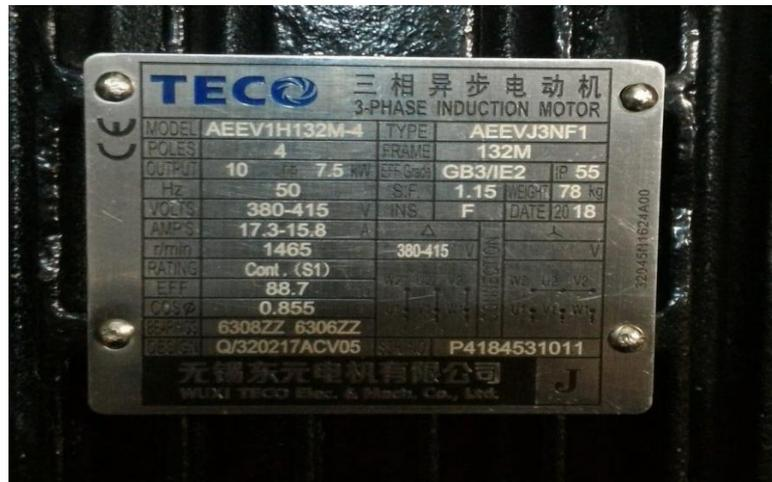
Gambar 2. 8 Spesifikasi Motoran *Tipler Hidraulic System*
